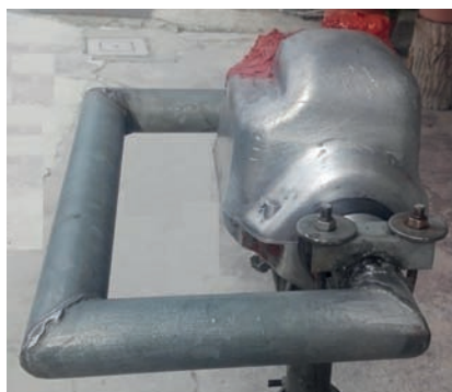
Fig. 6 - Supporto per l'ancoraggio della parabola, a montaggio ultimato.
