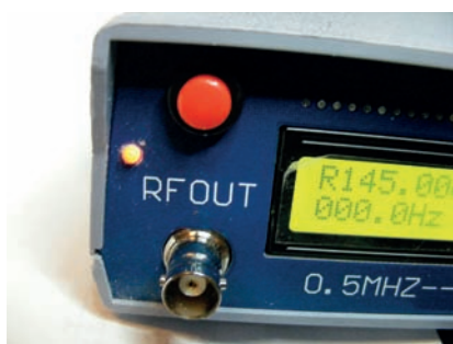
Foto 2 - Particolare nuovo LED.
