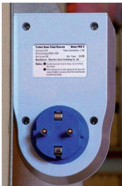
Fig. 2 - Parte posteriore del misuratore di potenza e consumo. In basso la spina Schuko da collegare alla rete.
