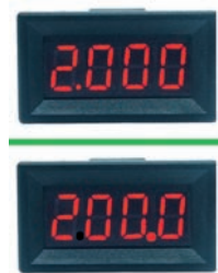
Fig. 10 - Il voltmetro digitale prima e dopo l'intervento sul punto.
