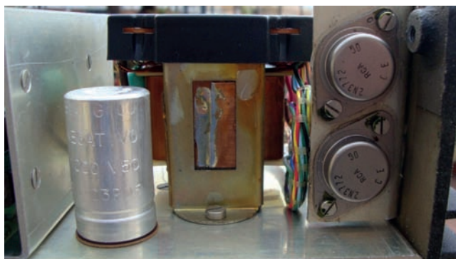
Fig. 6 - Vista del trasformatore di modulazione e dei transistor del push pull
