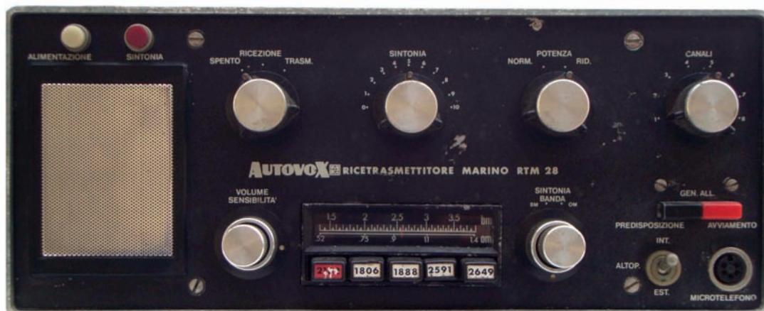
Fig. 1 - Pannello frontale del ricetrasmittitore marino RTM28 Autovox
