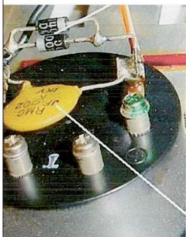
Inserzione di due diodi in antiparallelo o di un ponte di diodi ai capi del voltmetro con in parallelo una capacità di disaccoppiamento da 10nF 1kV. In caso di problemi nell'alimentatore lo strumento risulta protetto.
