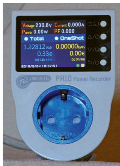
Fig. 1 - Aspetto frontale del misuratore di potenza e consumo. In basso la presa Schuko cui collegare il carico
