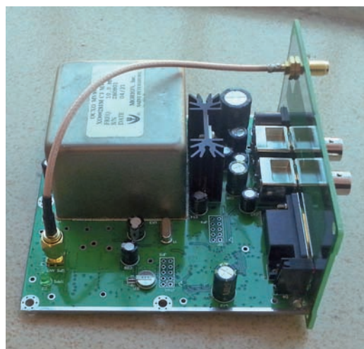
Fig. 3 - Interno del GPSDO, a sinistra, in alto, si vede un OCXO costruito dalla Morion di San Pietroburgo. Altri componenti, tra i quali il ricevitore GPS, stanno sulla faccia inferiore dello stampato.
