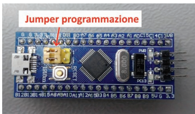
Fig. 1 - Scheda "blue pill" basata su STM32F103C8T6. Il form factor è quello stretto e lungo delle versioni più compatte di Arduino.
