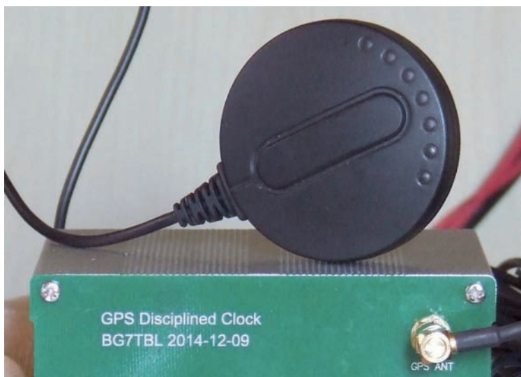
Fig. 2 - Antenna magnetica per GPS in dotazione al GPSDO. Il cavo è lungo 5 m, il connettore è di tipo SMA. L'antenna è amplificata in modo da compensare le forti perdite del cavo.
