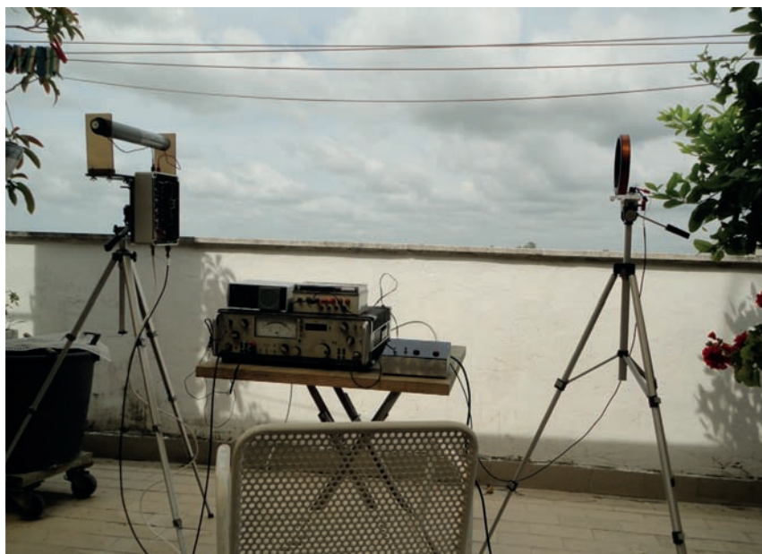
Fig. 13 - Set di controllo a sinistra captatore in prova, destra pseudo antenna TX.
