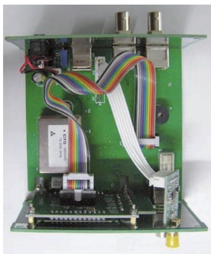
Fig. 4 - Lo strumento aperto visto da sopra. In basso a destra il prescaler. In basso a sinistra il display. Sopra al display si vede l'OCXO. L'immagine proviene da internet.
