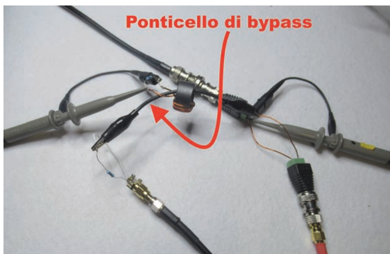
Fig. 7 - Con un filo dotato di coccodrilli proviamo a formare un percorso alternativo in parallelo ad uno dei conduttori della linea di trasmissione e vediamo quanta corrente vi scorre.
