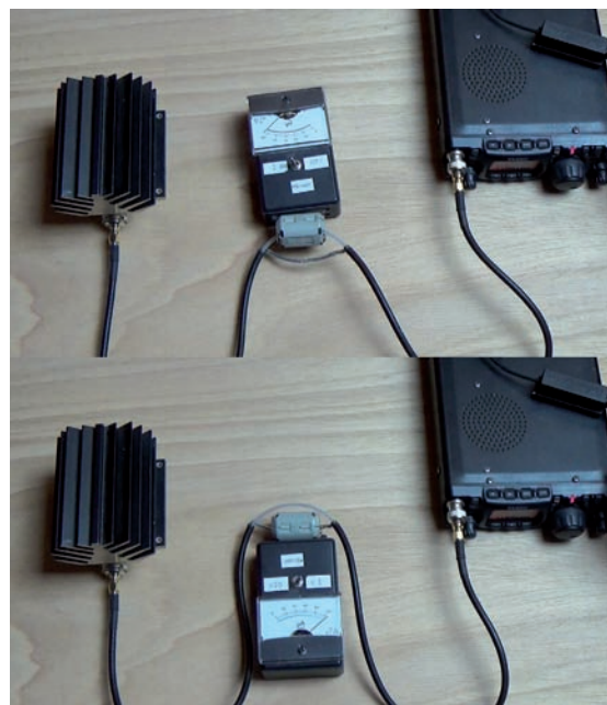
Fig. 1 - L'esperimento qui fotografato, in cui un amperometro RF viene posto sul centrale nell'immagine superiore e sulla calza in quella inferiore, mostra che la corrente scorre in entrambi i conduttori.
