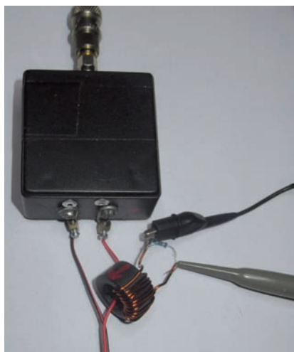
Fig. 6 - Misura della corrente su una linea bilanciata, in questo caso un doppino rosso-nero avente impedenza caratteristica pari a 150\Omega . Come si vede dal "misterioso" scatolino nero, per impiegare le linee bilanciate servono accorgimenti spiegate più avanti nel testo.
