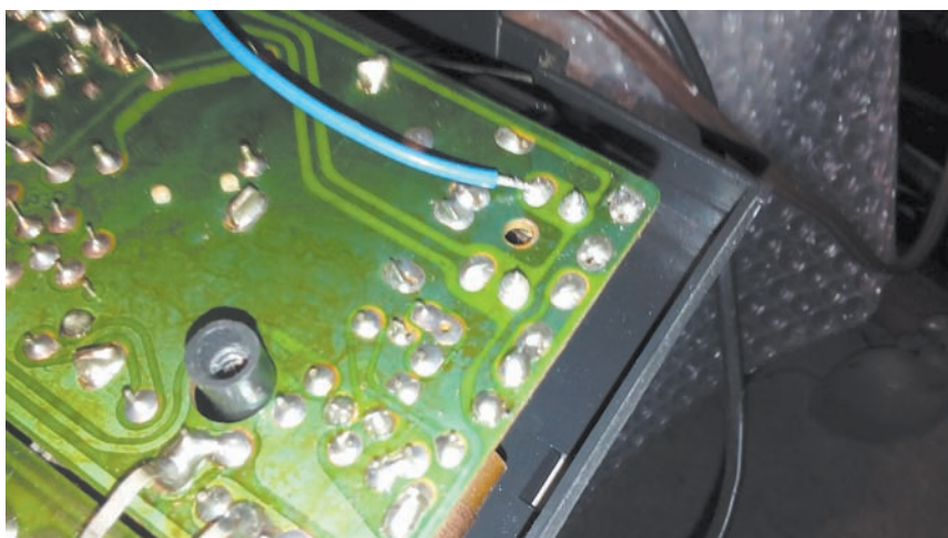
Punto collegamento antenna esterna AM
