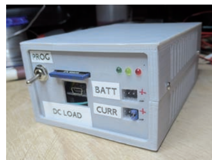
Fig. 9 - Questo è l'esemplare che da alcuni anni mette alla frusta tutte le batterie che mi capitano a tiro! Sul frontale le prese per la calibrazione. In particolare il jumper blu consente di interrompere il circuito della corrente per inserire un amperometro esterno e verificare la correttezza delle letture effettuate dall'apparecchio.
