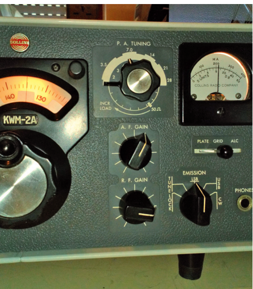
Fig. 4 - Errore di lettura frequenza con calibrazione a centrobanda: 200 Hz.
