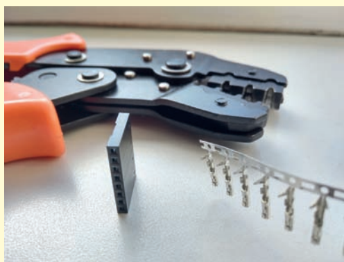
Fig. 12 - Connettori a crimpare e alloggiamento (vuoto) da 8 contatti. Sullo sfondo, la pinza per crimpare.
