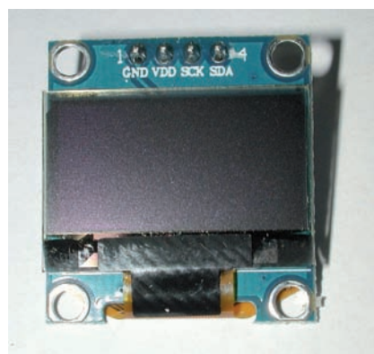
Fig. 7 - Display OLED 128x32pixel tipo "SSD1306"
