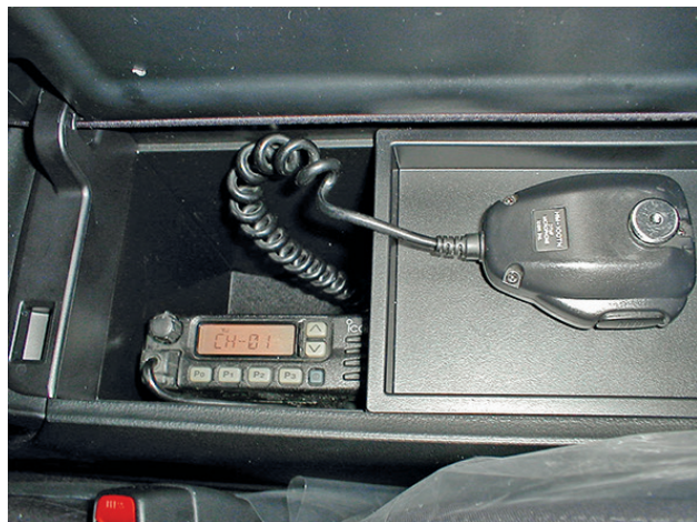
Radio EX_civile montata fissa nel vano sotto il bracciolo centrale.
