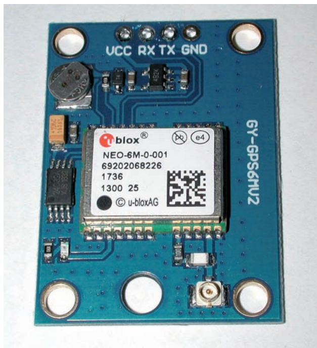
Fig. 5 - GPS basato su integrato UBLOX NEO-6M
