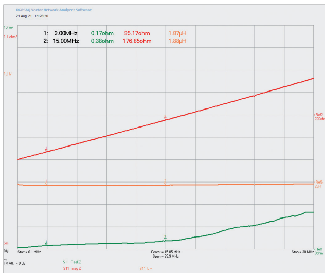
Fig. 2 - Analisi vettoriale dell'induttore di test nelle sue normali condizioni di funzionamento (0-30MHz). Il valore di induttanza rimane stabile, in questo caso attorno a 1.88μH mentre la resistenza (traccia verde) aumenta al crescere della frequenza. La reattanza, traccia rossa, è stabilmente legata da una formula al valore di induttanza.
