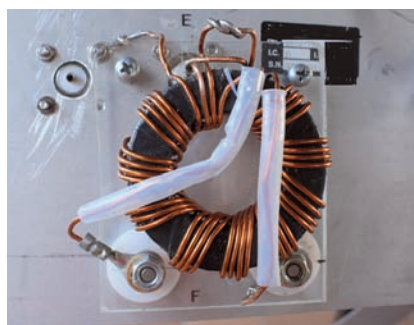
Foto 4 - Trasformatore RF un-bal
