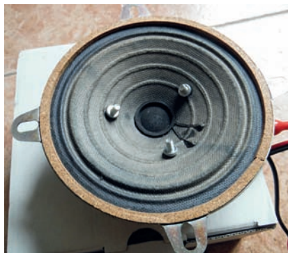
Fig. 5 - Esempio di misura del Vas tramite tre piccole masse aggiuntive.
