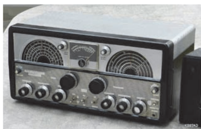
Ed infine SX 100 in origine alimentato a 110V necessitava di un adattatore per i 220V della rete: un amico compiacente realizzò un contenitore in legno per il trasformatore ed altoparlante con la stessa sagoma del ricevitore ed il tutto fu utilizzato per alcuni anni.
