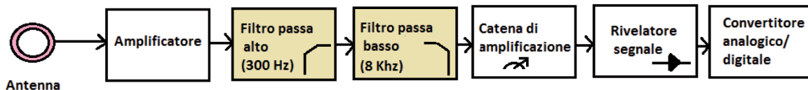
Schema a blocchi ricevitore Sismik
