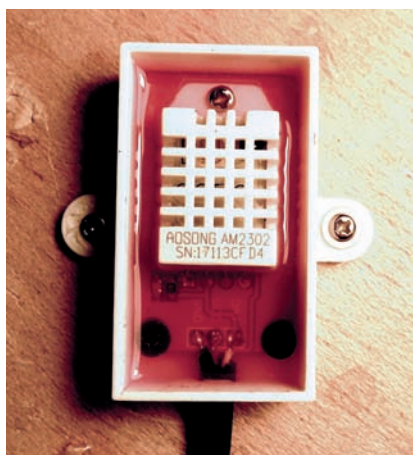
Fig. 5 - Sonda rilevatrice di temperatura ed umidità "DHT22". Il gel è stato colato in modo da raggiungere esattamente il livello al quale comincia la griglia bianca; in questo modo i circuiti e le saldature sottostanti sono totalmente protetti mentre i sensori rimangono esposti all'atmosfera.
