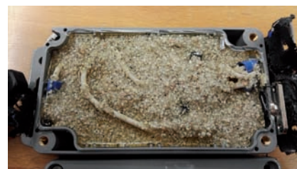
Fig. 1 - Trasformatore di impedenza commerciale immerso in resina mista a sabbia, presumibilmente per occultarne il contenuto (foto tratta da AriFidenza.it).
