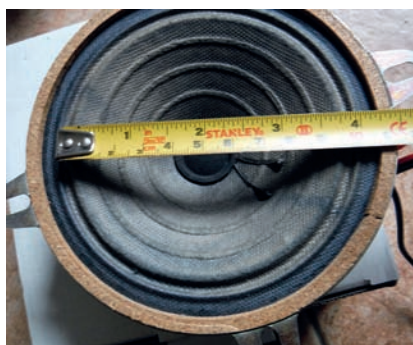
Fig. 4 - Esempio di rilievo del diametro effettivo del cono.
