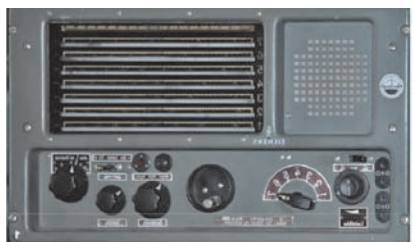
IL SIEMENS E66a , alimentazione diretta a 220V con utilizzo di valvole multifunzione metalliche tedesche introvabili.
