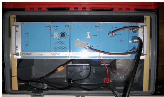
Fig. 2 - Ripetitore in FM trasportabile in valigia utilizzato come ponte mobile per comunicazioni di terzo livello
