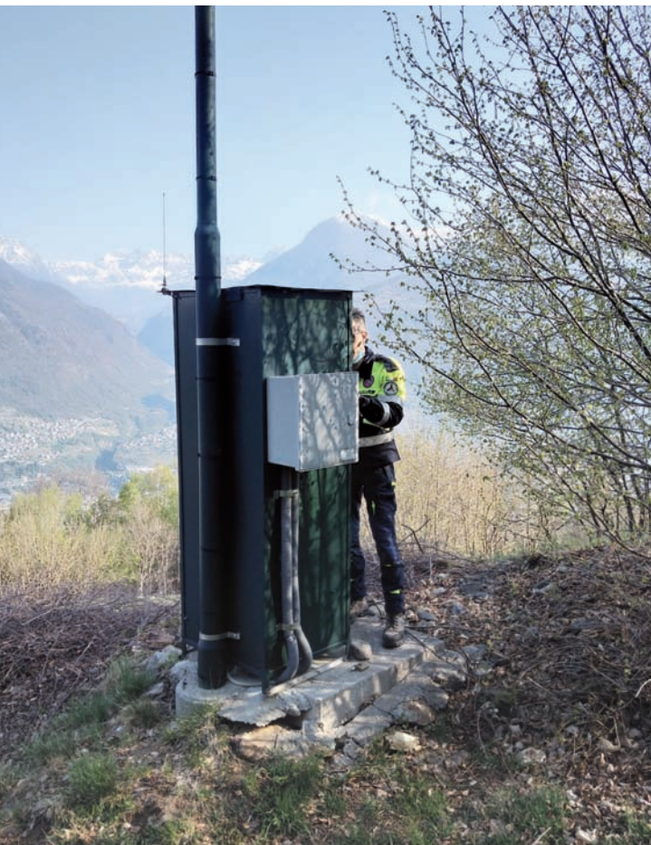
Fig. 3 - Postazione fissa ripetitore FM/DMR. Questi ripetitori sono impiegati dalle associazioni di P.C. quando operano sul loro territorio di competenza.
