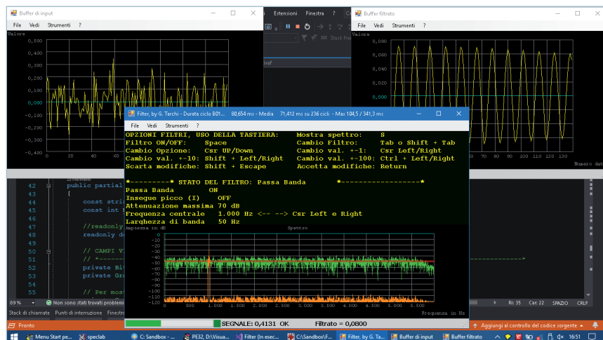
Fig. 11 - Schermata principale di Filter (al centro in basso), segnale in ingresso (in alto a sinistra) e segnale in uscita, filtrato (in alto a destra). Si vedono due spettri: quello verde è prima del filtro, quello arancione dopo. Sullo sfondo il formidabile Microsoft Visual Studio 2019 (ora lo aggiorno sempre!).
