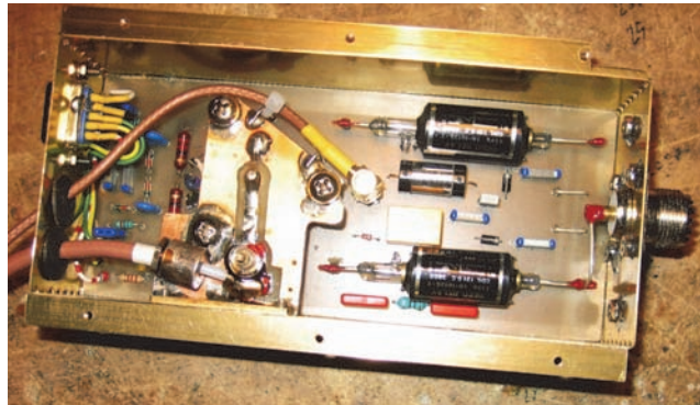
Misuratore SWR e relè antenna
