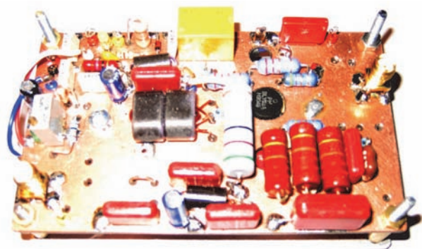
Stadio Driver Le posizionata sotto il PCB.
