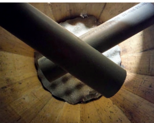
Fig. 4 - Vista interna della botte durante la costruzione. Notare i due condotti di accordo e lo strato di fonoassorbente sul fondo
