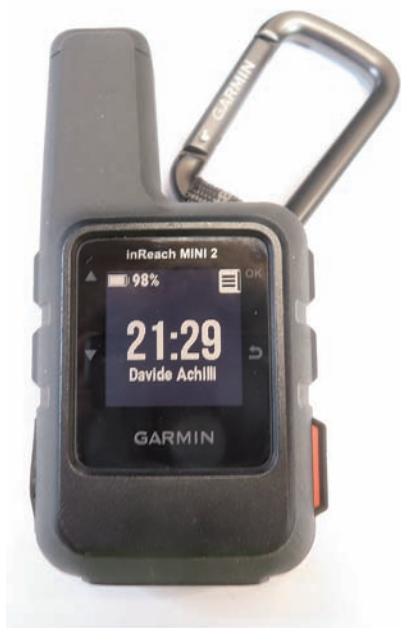
Figura 2 - Apparato satellitare Garmin InReach mini 2. Con 100g di peso e quasi 30 giorni di autonomia con una sola ricarica, è un dispositivo fondamentale per la propria sicurezza in montagna.
