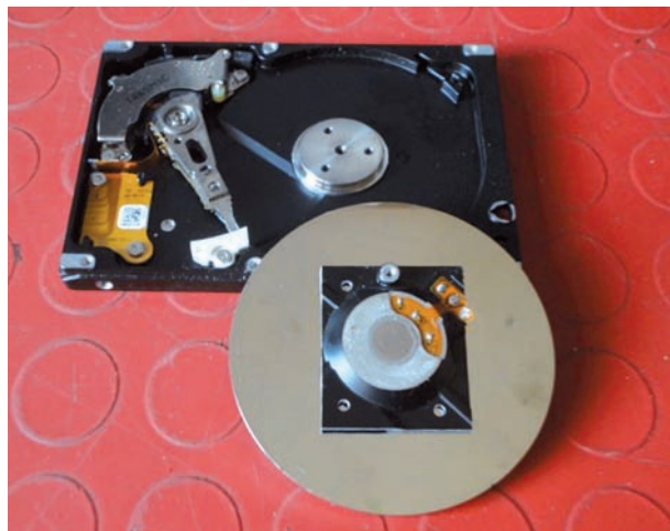
Fig. 3 - Hard disk PC portatile, motorino recuperato con disco.
