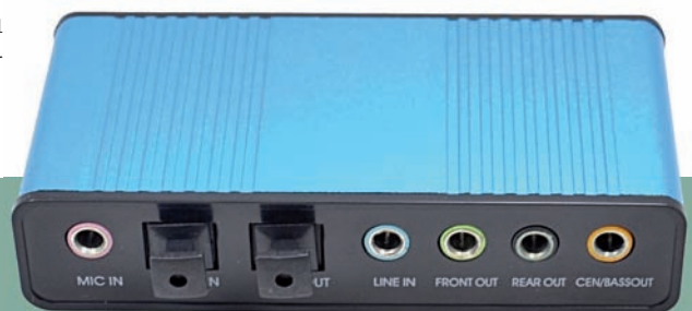
Fig. 1 - La prima scheda audio USB con l'integrato C-Media CM6206, acquistata dall'autore nel luglio 2021. Sul retro, non visibile, un connettore USB femmina Mini-A permette di collegarsi al PC.
