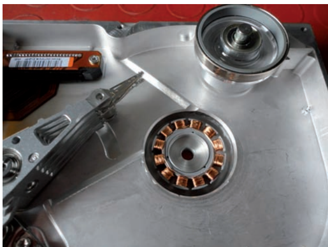
Fig. 2 - Motorino con statore inserito sul corpo del Hard disk.
