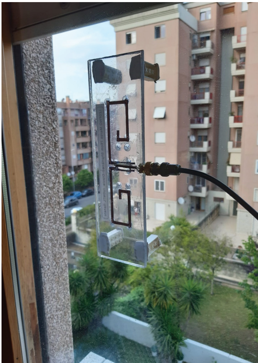
Figura 9 - Il dipolo montato sul vetro della finestra
