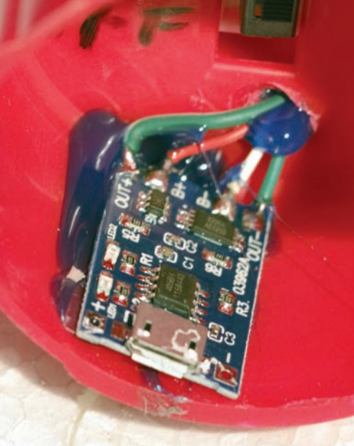
Figura 2 - Modulo di controllo batteria installato nel fondello a fianco dell'interruttore
