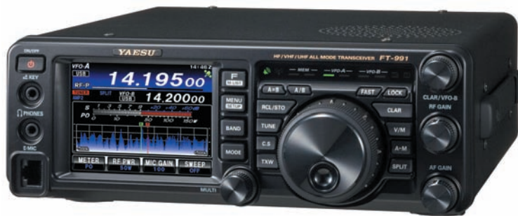
Fig. 2 - All'opposto del suo antenato, FT-One, il piccolo FT-991 ha un pannello alquanto sobrio, ma le possibilità d'intervento sono tantissime, grazie a un ricco sistema di menu ed allo schermo touch screen che mostra pulsanti legati al contesto.
