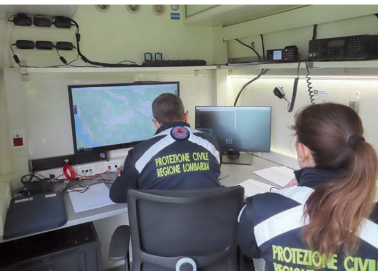
Figura 1 - Interno di un Centro Trasmissioni Mobile. Ascoltare le comunicazioni con più apparati che "parlano" in uno spazio così ristretto, è alquanto problematico.
