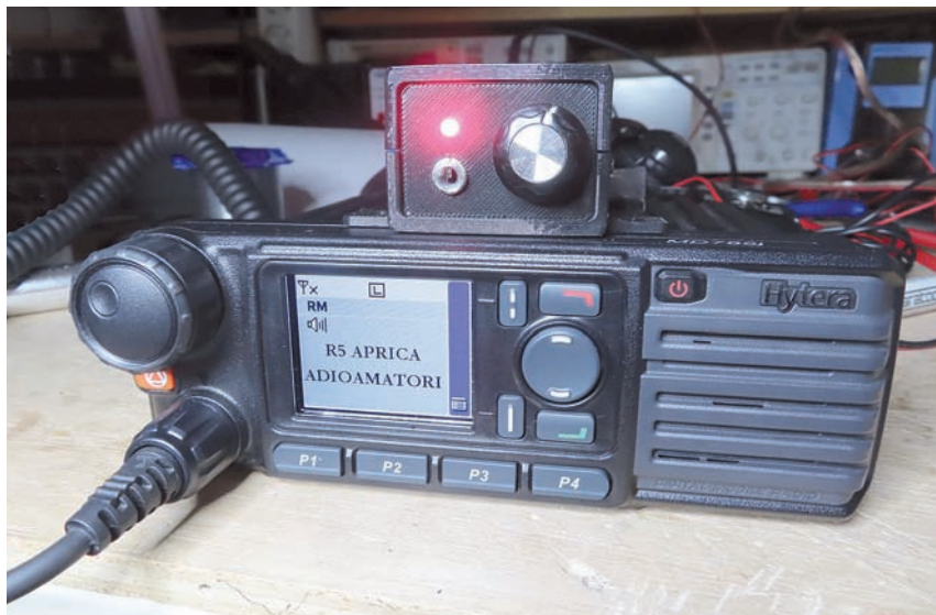
Figura 9 - Amplificatore montato al di sopra di un apparato civile Hytera. In questo caso, vista la relativamente debole amplificazione e la lunghezza ridottissima dei collegamenti, non è nemmeno necessario un cavetto schermato.
