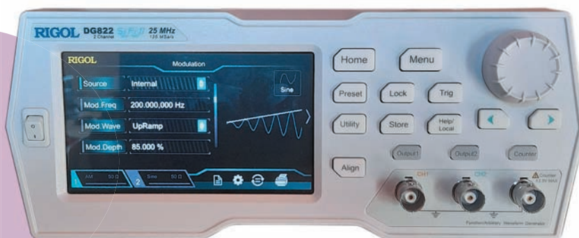
Fig. 1 - Il DG822 dell'autore. Il display mostra il menu della modulazione. L'immagine sulla destra del display mostra come sarà la FDO risultante e cambia variando le opzioni.
