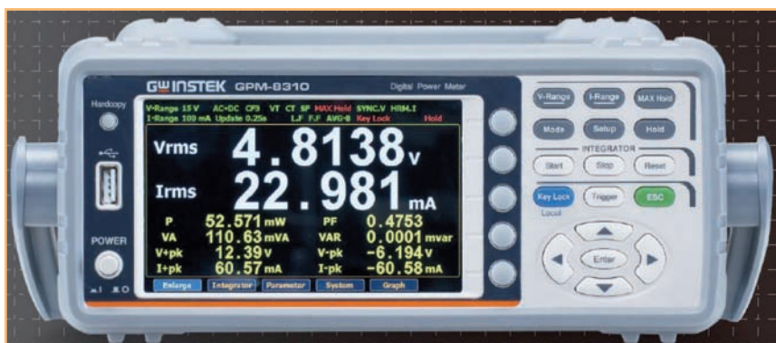
Figura 3 - Il wattmetro GPM-8310 permette misure di consumo molto accurate in un ampio range di tensioni e correnti. Per i dilettanti, il solo problema è il prezzo.
