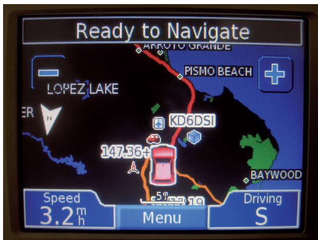
Figura 2 - Navigatore portatile Garmin Nüvi 350 interfacciato tramite cavo GTRANS a un apparato Yaesu FTM-350R. Con un setup di questo tipo, vengono visualizzate in tempo reale le posizioni dei nodi APRS circostanti ricevuti via radio senza alcun ausilio da parte di internet.
