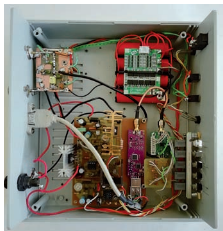
Fig. 11 - Interno dell'apparecchio montato
