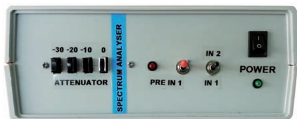
Fig. 12 - Possibile disposizione del pannello frontale
