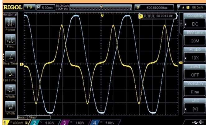
Figura 1 - Corrente primaria (traccia gialla) e tensione al secondario (traccia celeste) in un trasformatore d'isolamento 230/230 V alimentato con 268 V (280 al secondario) per esasperare le distorsioni. La corrente sembra in anticipo, perché ho inserito la spina all'inverso e me ne sono accorto dopo avere smontato tutto. Perdonatemi la pigrizia.
