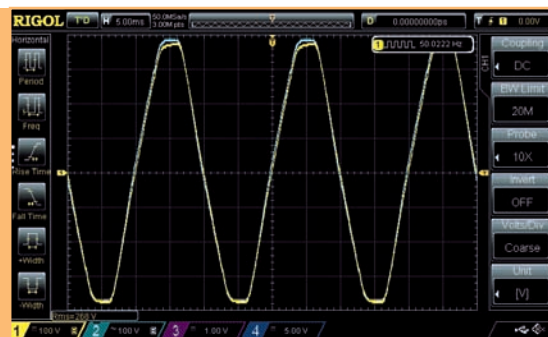
Figura 2 - Forme d'onda delle tensioni: al primario (traccia gialla) e al secondario (traccia celeste) del solito trasformatore d'isolamento 230/230 V. Il primario è alimentato con 268 V per distorcere al massimo la corrente di magnetizzazione, ma la tensione secondaria è poco distorta, solo un pizzico più della primaria.
