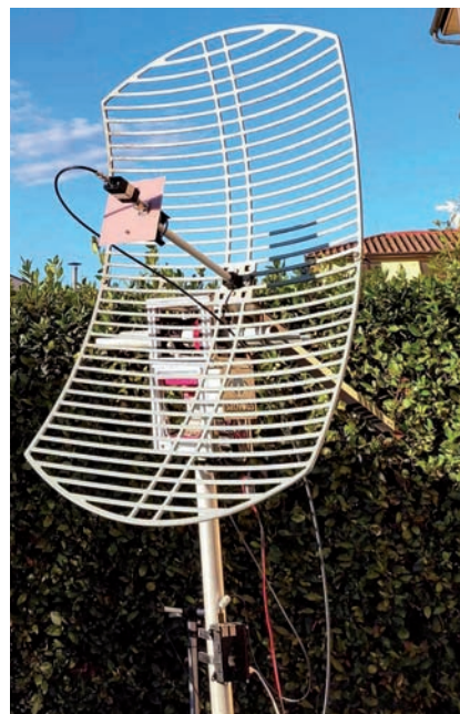
Foto 8 - Antenna WIFI a griglia con illuminatore LHCP a 5,5 spire montato su rotore SatNOGS
