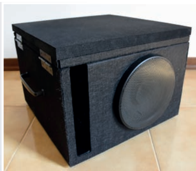
Vista di un altoparlante e relativo condotto reflex
