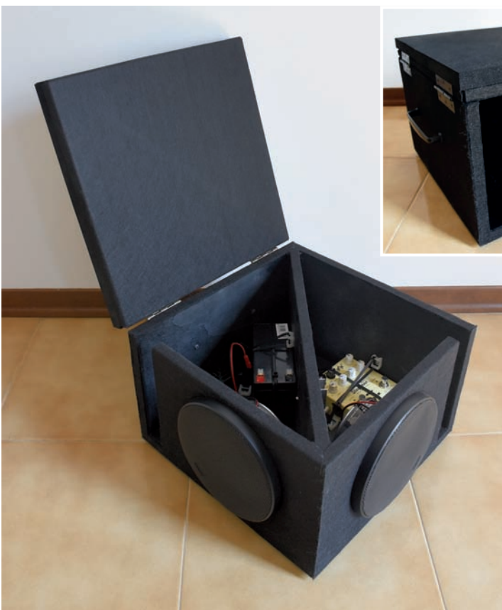
Vista di un altoparlante e relativo condotto reflex
