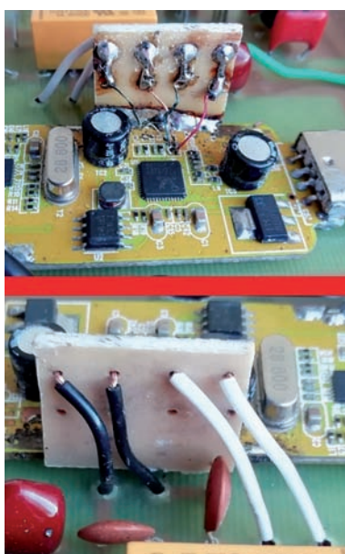
Fig. 14 - I collegamenti con la chiavetta
