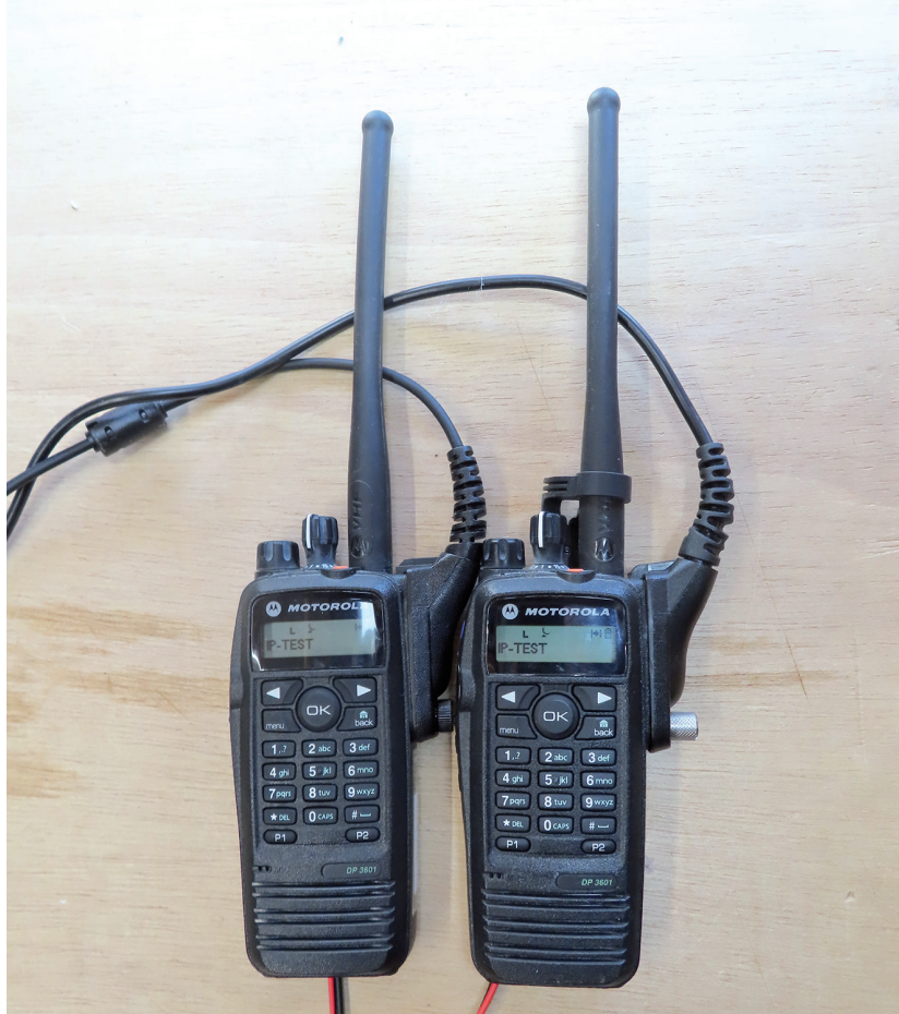
Figura 2 - Due apparati Motorola DP 3601 impiegati nei test di trasmissione dati.
