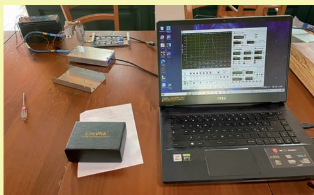
Test con Pluto VNA a 20 GHz
