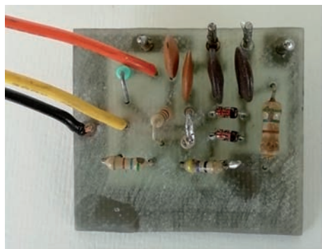
Fig. 8 - La basetta da saldare direttamente sul connettore HF
