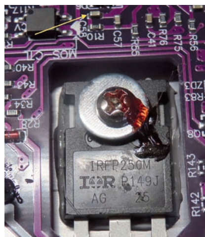
Figura 8 - Immagine di uno dei MOSFET e, nella parte superiore indicato dalla freccia gialla, il condensatore C58 responsabile del ripple.
