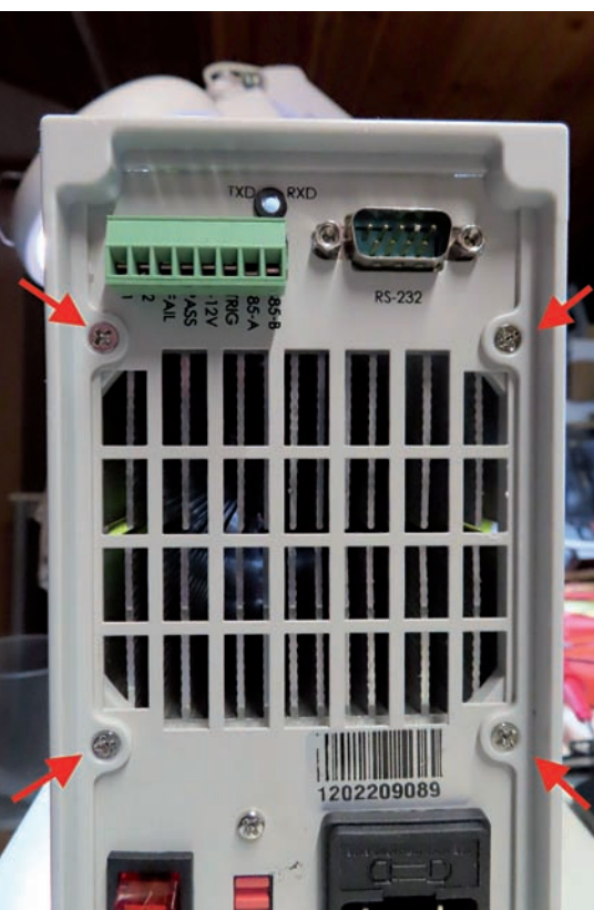
Figura 9 - Le quattro viti sul retro sono avvitate sul dissipatore, che è elettricamente collegato al polo positivo sull'ingresso frontale. Pertanto, su queste quattro viti troviamo il positivo della tensione sotto carico, che, secondo specifiche dell'apparecchio, può arrivare a 150 V.
