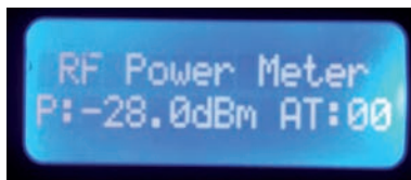
Foto 11 - Potenza misurata con 20dB di attenuazione
