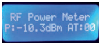
Foto 10 - Potenza misurata con 0dB di attenuazione
