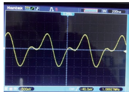
Foto 3 - Vista all'oscilloscopio della forma d'onda risultante dalla somma di f1 e f2
