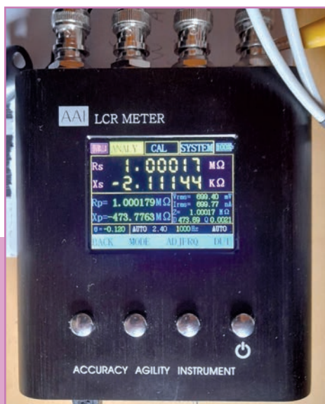
Fig. 1 - Il piccolo NJ100S impegnato nella misura di un resistore di precisione, una cassetta a 6 decadi RDS-615B, allo 0,005%, regolata per 1 MΩ.
