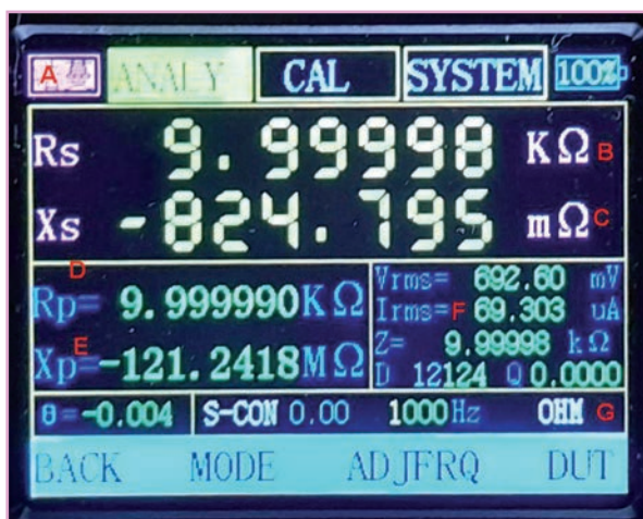
Fig. 3 - Il display dello strumento mentre misura un resistore da 10.000 \Omega , 0,005%, sul quale è stato calibrato due mesi prima. Descrizione nel testo
