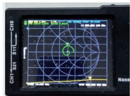
Foto 15 - Vista al NanoVNA della misura di SWR
