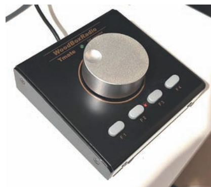
Figura 3 - E' qui raffigurata l'unità Tmate della WoodBoxRadio, una delle possibili interfacce che, assieme ad un monitor per PC, consentono l'utilizzo dei ricevitori "black-box" via RS-232.
