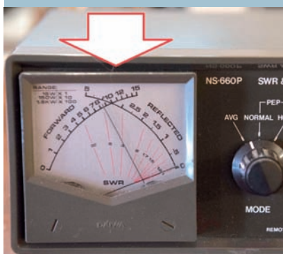
Figura 8 - Il rosmetro ad aghi incrociati usato per le prove, modello Daiwa NS-660P, posto all'ingresso dell'accordatore (lato RTX), indica una potenza diretta di 8,5 W, e una potenza riflessa praticamente nulla.
