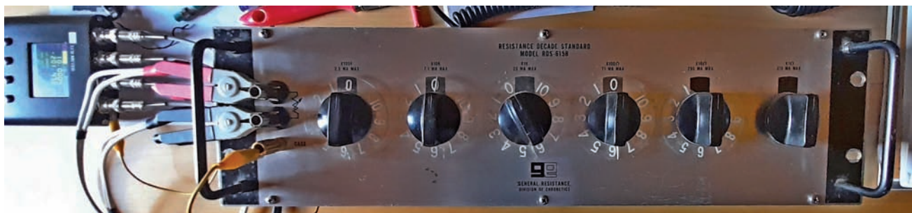
Fig. 3 - La cassetta a decadi RDS-615B usata per buona parte delle misure e per la calibrazione Load. La cassetta è regolata per 10 kΩ con 10 resistori da 1 kΩ in serie. La manopola è nella posizione 11, non marcata, ma del tutto equivalente alla 10.
