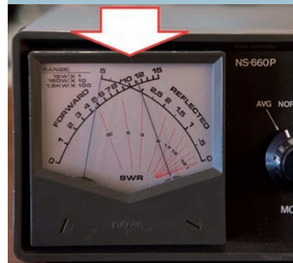
Figura 9 - Qui il rosmetro è posto all'uscita dell'accordatore (lato antenna), e sulla scala della potenza diretta indica circa 11 W, mentre su quella della potenza riflessa indica 5W.
