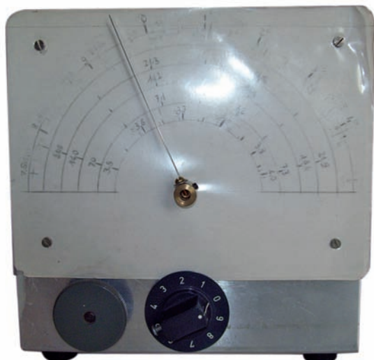
Foto 1 - Il ricevitore a conversione diretta
