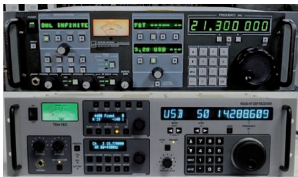
Figura 1 - I ricevitori WJ-8711A (sopra) e Ten-Tec RX-340 (sotto). Si noti la relativa somiglianza strutturale dei pannelli frontali
