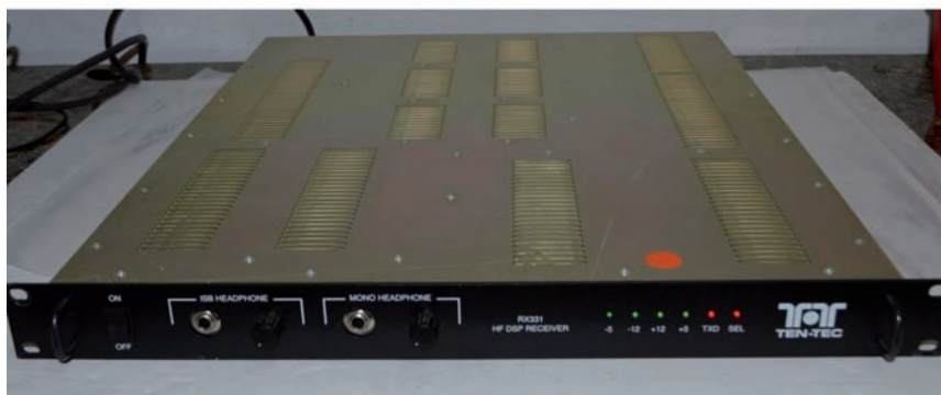
Figura 2 - I ricevitori WJ-8712A (sopra) e Ten-Tec RX-331 (sotto). Mentre il modello della Watkins-Johnson è alto due unità rack e largo mezza, quello della Ten-Tec si sviluppa meno in altezza (una sola unità rack) e più in larghezza (rack standard 19"). Entrambi i ricevitori sono comunque piuttosto profondi (più di 50 cm)
