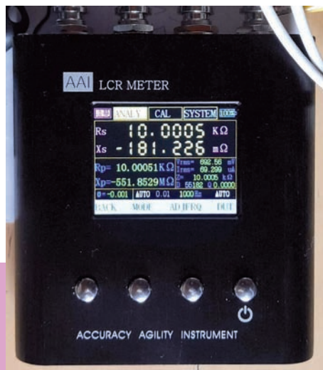
Fig. 1 Lo strumento, appena acceso, sta misurando un resistore da 10 k \Omega .
