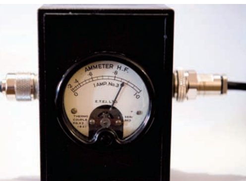
Figura 15 - L'amperometro RF utilizzato nelle prove, uno strumento vintage a termocoppia, in grado di misurare correnti RF, nello spettro HF, fino a 1 A.
