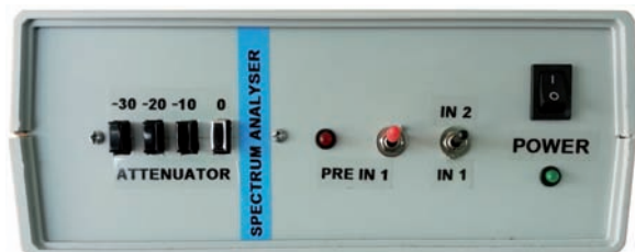
Fig. 12 - Possibile disposizione del pannello frontale
