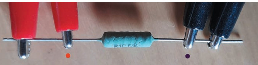
Fig. 1 - Misura di un resistore a filo da 100 mΩ. I cerchietti rosso e nero individuano i terminali sense, col metodo a quattro fili la resistenza è misurata tra questi. Un solo centimetro di reoforo in più o in meno cambia il risultato di 0,35 mΩ (sezione 0,5 mm²).
