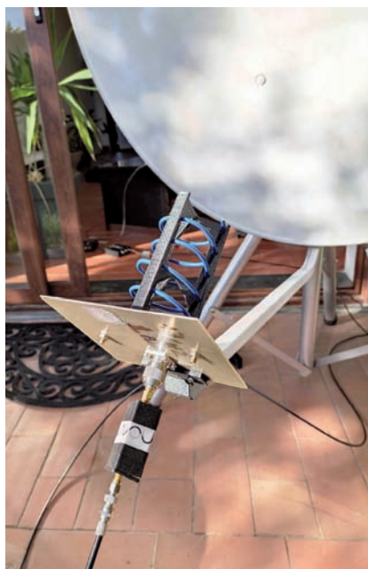
Foto 5 - illuminatore 5,5 spire stampato in Pet-g e costruito su basetta di vetronite con spire in semplice filo elettrico
