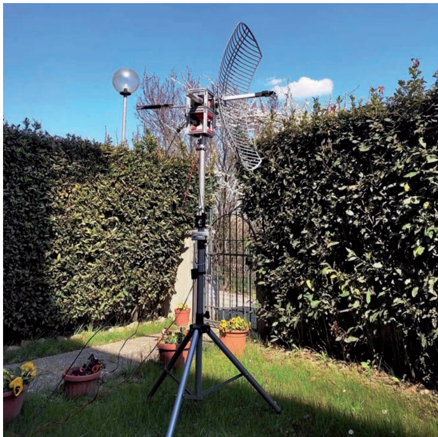
Foto 4 - Rotore SatNOGS con parabola wifi da 24dB a griglia, utilizzato per 1.7 GHz
