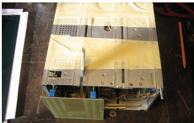
Allineamento e saldatura dei connettori
