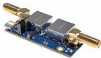
Foto 2 - Preamplificatore + saw filter a 1698 MHz
