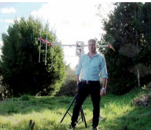
Foto 6 - Rotore SatNOGS da me costruito e attualmente utilizzato in portatile
