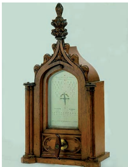
Foto 2 - Quadrante alfabetico di una prima serie commerciale del telegrafo Cooke-Wheatstone
