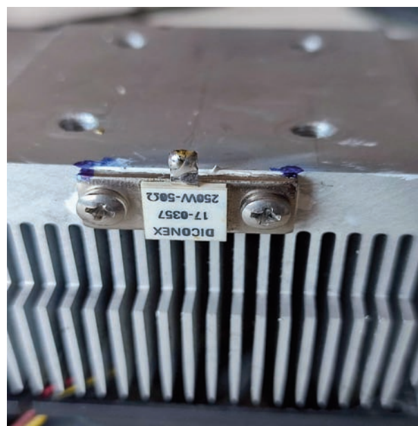
Foto 2 - Predisposizione dissipatore con terminazione
