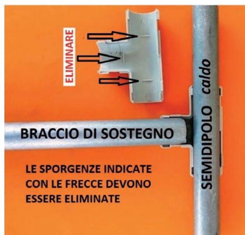
Fig. 13 - Preparazione e montaggio del raccordo T ispezionabile
