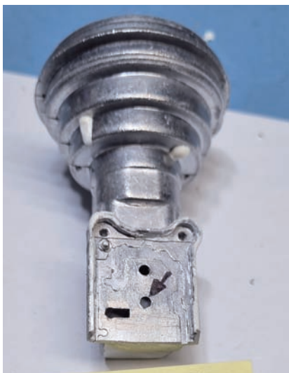
Foto 8 - Foro dove montare SMA
