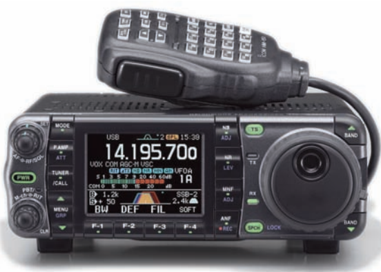
Figura 6 - La frequenza dell'Icom IC-7000 è determinata, in pratica, solo da un TCXO. I risultati sono ottimi, anche sulle gamme VHF e UHF.
