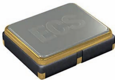
Figura 2 - TCXO per montaggio SMD. Questi dispositivi offrono stabilità di 0,5-1 ppm, ma ne esistono anche di migliori (0,1 ppm).
