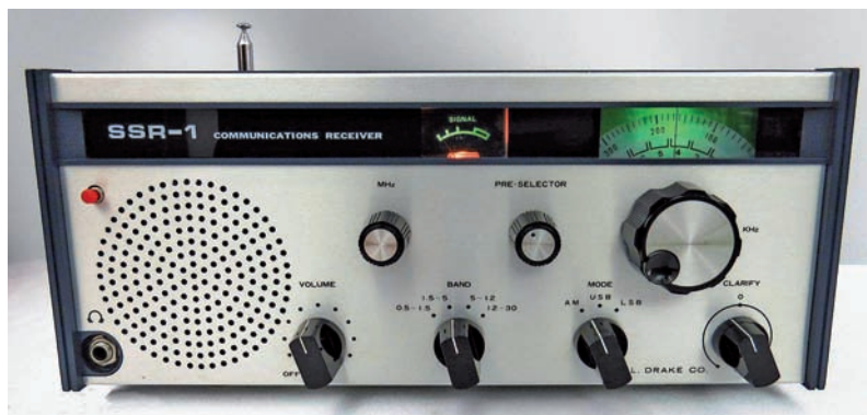
Figura 3 - Il Drake SSR-1, dotato di riferimento misto VFO LC e quarzo, offriva una stabilità accettabile in tutte le trenta gamme, da 0,5 a 30 MHz. I VFO LC sono due. Il primo, con un'ampiezza di 1 MHz, è quello della sintonia. Il secondo, con un'ampiezza di 30 MHz è quello per selezionare le 30 gamme da 1 MHz. Il secondo VFO è reso stabile dal Wadley loop system. Maggiori dettagli sono su Rke 7-8/2014, nel riquadro alle pag. 44-45
