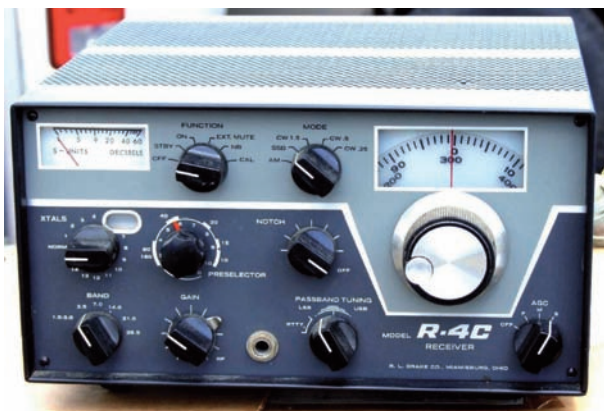
Figura 4 - Il Drake R-4C ha un riferimento misto: VFO LC e cristalli di banda. Grazie anche al valido VFO offre una discreta stabilità. Il commutatore "BAND" cambia le bobine del preselettore. Il cambio di gamma è affidato al commutatore "XTALS". La scala è lineare, 500 kHz per gamma.
