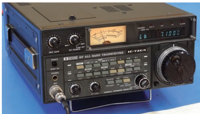
Figura 5 - L'IC-720 ha un riferimento di frequenza basato su più quarzi e offre una buona stabilità
