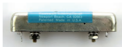
Figura 4 - Filtro meccanico a 455 kHz di produzione Rockwell - Collins. Sono componenti che danno buoni risultati, ma superati dai migliori filtri a quarzo e dai filtri DSP.
