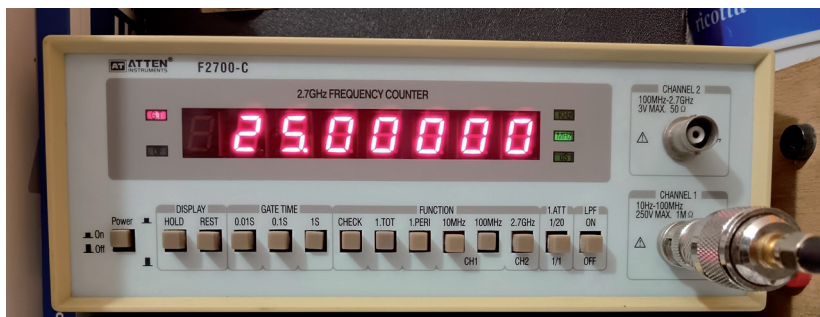
Foto 3 - Misura frequenza TCXO, dopo pochi minuti di accensione
