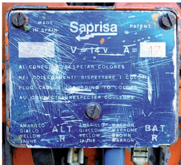
Figura 1 - Il regolatore di tensione del mio trattore
