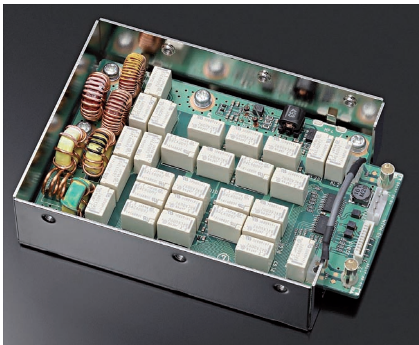
Figura 2 – Il modulo preselettore RF dell'apparato IC-7610, circuito che esalta l'alta dinamica delle sue due sezioni riceventi. Si osservi la dominante presenza dei ventotto relè adibiti alla rete di commutazione degli induttori e condensatori che implementano il filtro.
