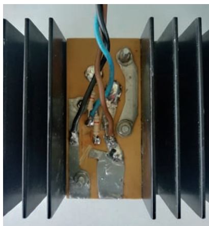
Fig. 10 - Il montaggio di una coppia di transistor finali su un dissipatore
