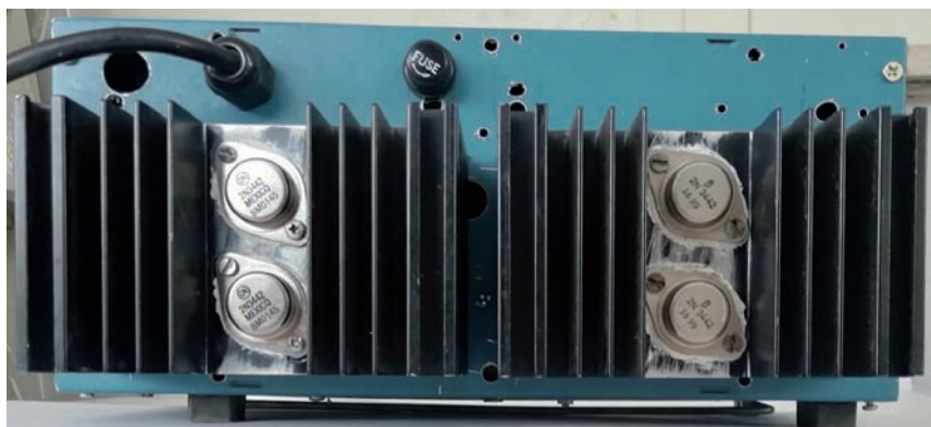
Fig. 12 - I transistor di potenza montati sui dissipatori
