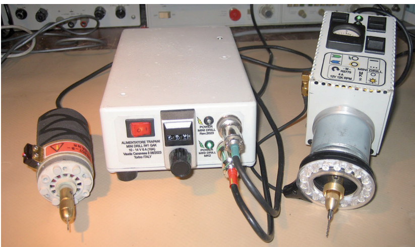
Mini Drill unità predisposte per supporto a colonna e manuale.
