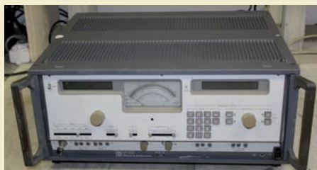
Il modello SPM-18, identico all'SPM-19 ma privo di funzioni scan, sweep, AFC etc.
