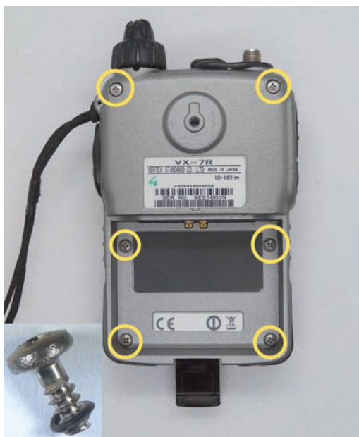
Figura 7 - Per aprire l'apparato vanno tolte sei viti. Attenzione alle microscopiche guarnizioni che rimangono sui filetti delle viti, come si vede nel riquadro in basso a sinistra.
