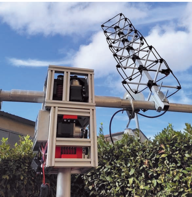
Foto 1 - La cubical quad 7 elementi montata su rotore SatNOGS
