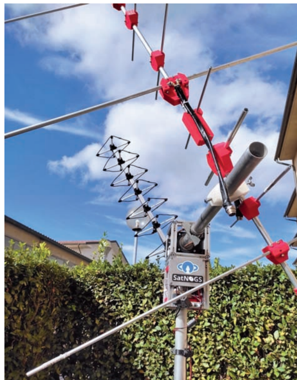
Foto 2 - La cubical quad 7 elementi + Yagi VHF/UHF per traffico satellitare
