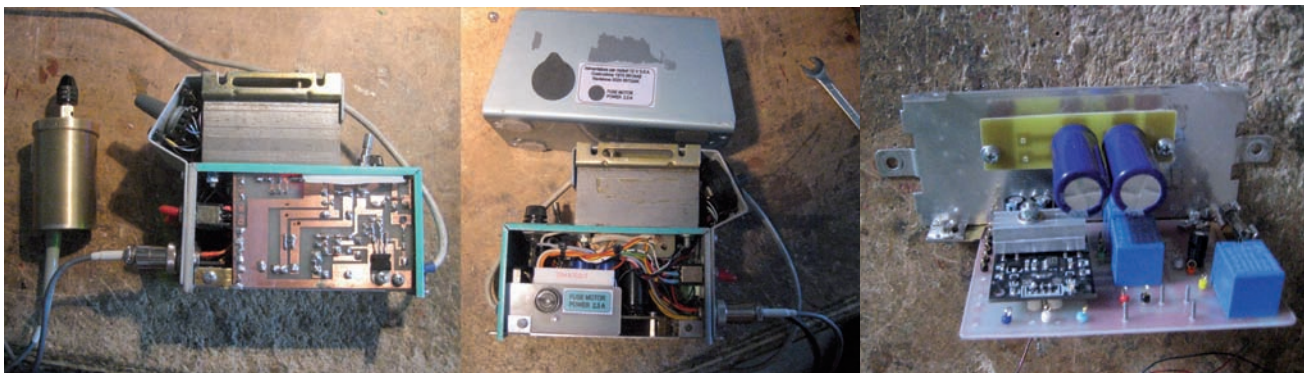
Vista interna e PCB dell'alimentatore motori Mini Drill Ver.2023.
