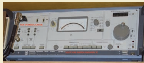
Un SPM-12 provvisto di demodulatore SSB e di semplice calibratore
