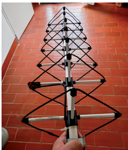
Foto 4 - Cubical quad, essendo leggera si tiene tranquillamente in mano per il tracking satellitare
