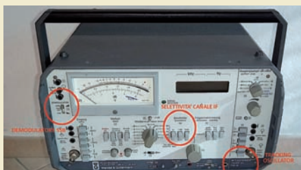
Un SPM-30 provvisto sia di demodulatore SSB che di tracking oscillator
