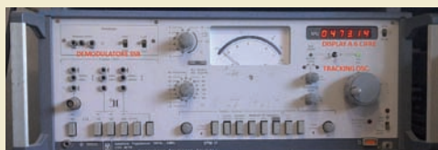
Un SPM-12 provvisto di demodulatore SSB, display a 6 cifre e tracking oscillator.
