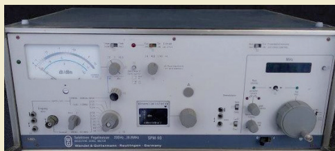
Un SPM-60 provvisto di tracking oscillator e di demodulatore SSB.
