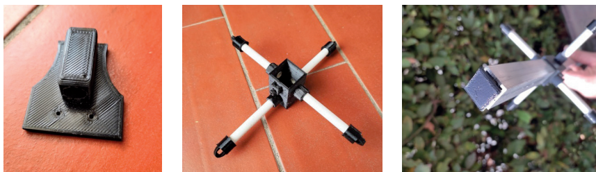
Foto 5 - I modelli stampati in 3D necessari alla costruzione, notare l'inserito con dado M3 per bloccare la crociera sul boom
