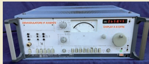
Un SPM-12 privo di demodulatore SSB e provvisto di display a 6 cifre con semplice calibratore
