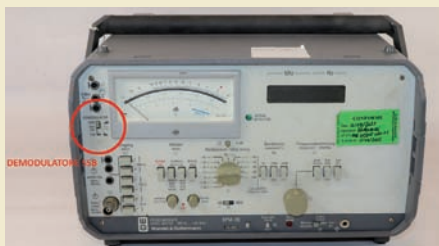
Un SPM-30 provvisto di demodulatore SSB ma privo di tracking oscillator
