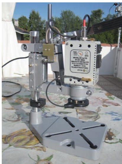
Supporto trapano dopo le modifiche attuate per PCB
