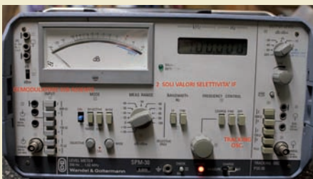
Un SPM-30 provvisto di tracking oscillator ma privo di demodulatore SSB. Si noti in questo esemplare la possibilità di scelta tra due soli valori di banda-passante (24 Hz e 1,74 kHz).
