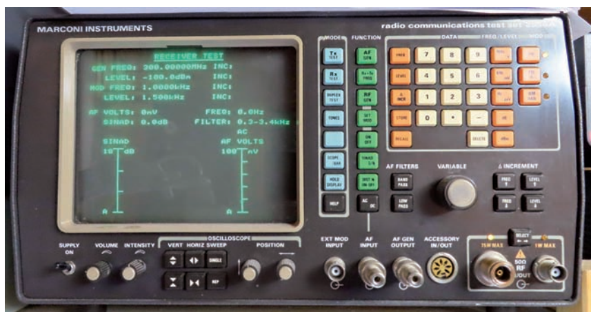
Figura 2 - Test set Marconi 2955A: questi strumenti da laboratorio misurano automaticamente il SINAD e consentono di verificare la sensibilità degli apparati.
