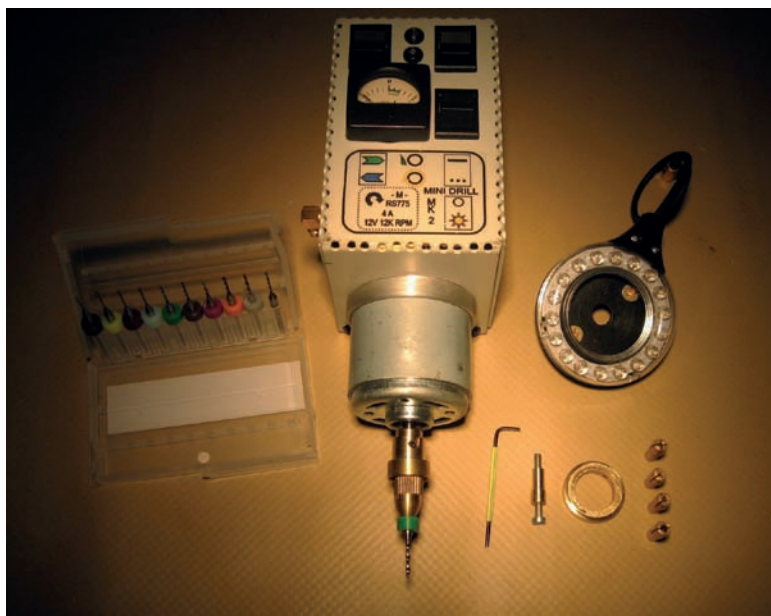
Accessori gruppo di foratura, illuminatore a LED, chiave ridotta, estrattore e collare sblocco mandrino, coni mandrino
