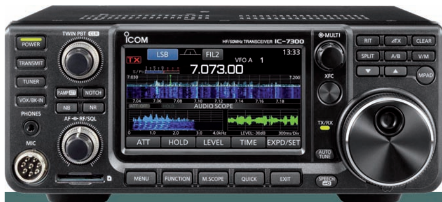
Figura 1 - L'IC-7300, piccolo ed economico, offre mille possibilità di regolazione. Nella foto si vedono molti dei controlli citati nell'articolo. L'apparato è un SDR a digitalizzazione diretta, senza alcuna conversione di frequenza analogica (ne ha una digitale).
