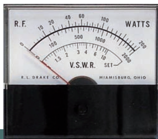
Figura 2 - Lo strumento dell'attempato, ma sempre valido, adattatore d'impedenza Drake MN-2000. Ovviamente, nell'uso non occorre che l'indicatore del ROS (VSWR) sia esattamente sull'1, come in figura
