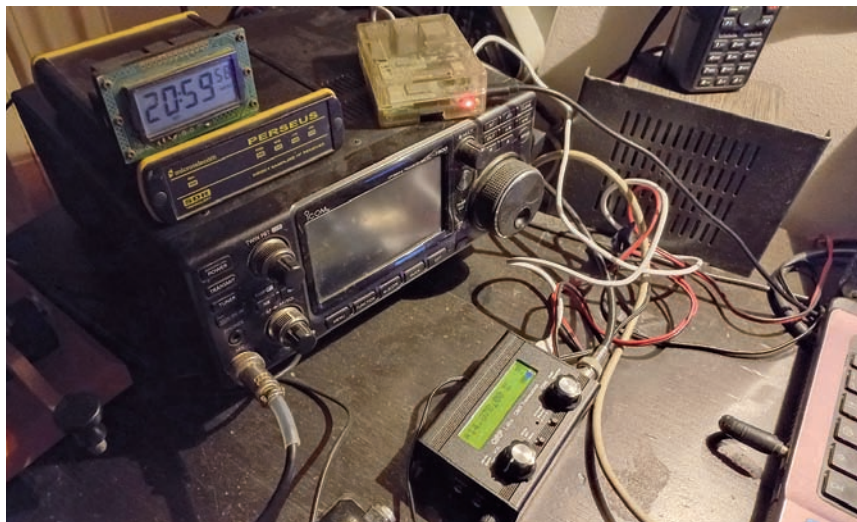
La mia stazione radio con il Raspberry PI usato per controllare a distanza il QMX
