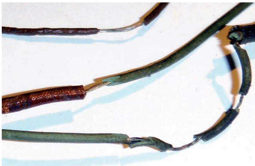
Figura 7 - Esempi di cavi con isolante screpolato o sbriciolato
