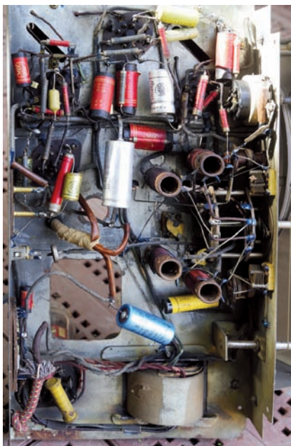
Figura 7 - Esempi di cavi con isolante screpolato o sbriciolato
