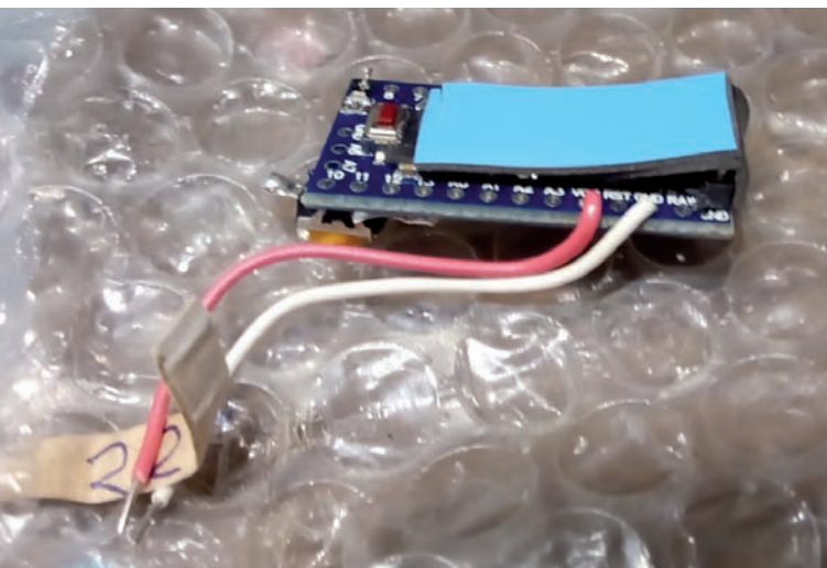
Arduino con biadesivo di fissaggio su lato superiore
