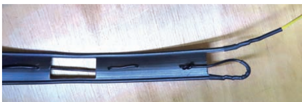
Figura 6 - La parte "trifilare" si può ottenendo usando una piattina bifilare a 450 ohm al centro della quale sono praticati dei fori nei quali passa il terzo cavo centrale
