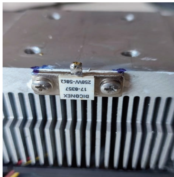
Foto 2 - Predisposizione dissipatore con terminazione
