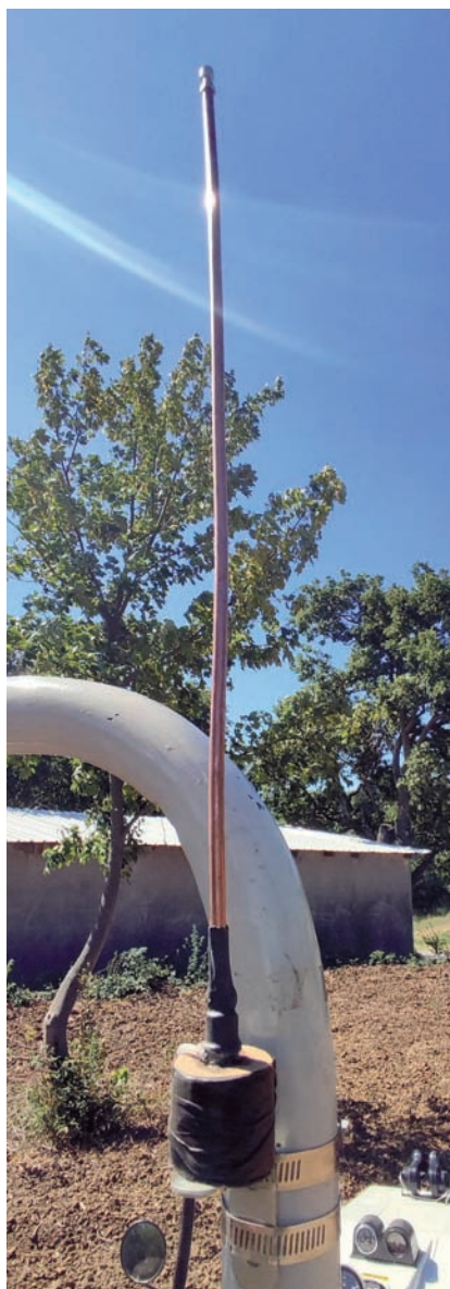
Figura 11 - L'antenna "antitutto" montata sull'arco di protezione del trattore
