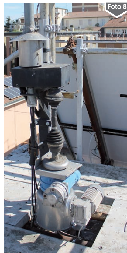
Foto 7 - Rotore "passante" completo di carter antipioggia, pronto per messa in opera.
