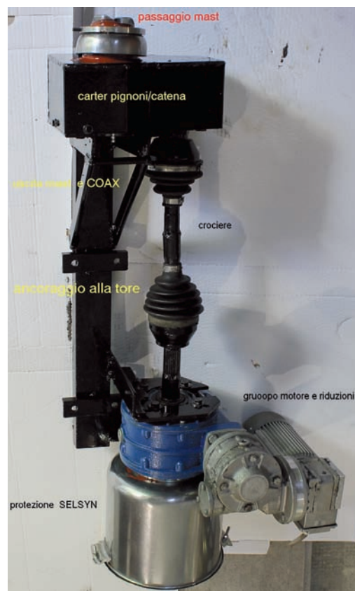
Foto 7 - Rotore "passante" completo di carter antipioggia, pronto per messa in opera.
