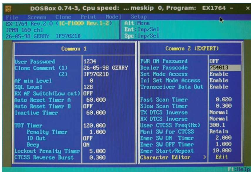
Figura 10 - In questa schermata è possibile configurare le password di accesso (se si usano), il livello di squelch, il livello minimo di audio, vari timer e funzioni
