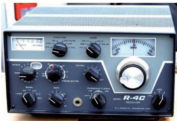
Figura 4 - Il Drake R-4C, valido ricevitore d'altri tempi. Esso veniva migliorato, per gli amanti del CW, con i kit di Rob Sherwood.
