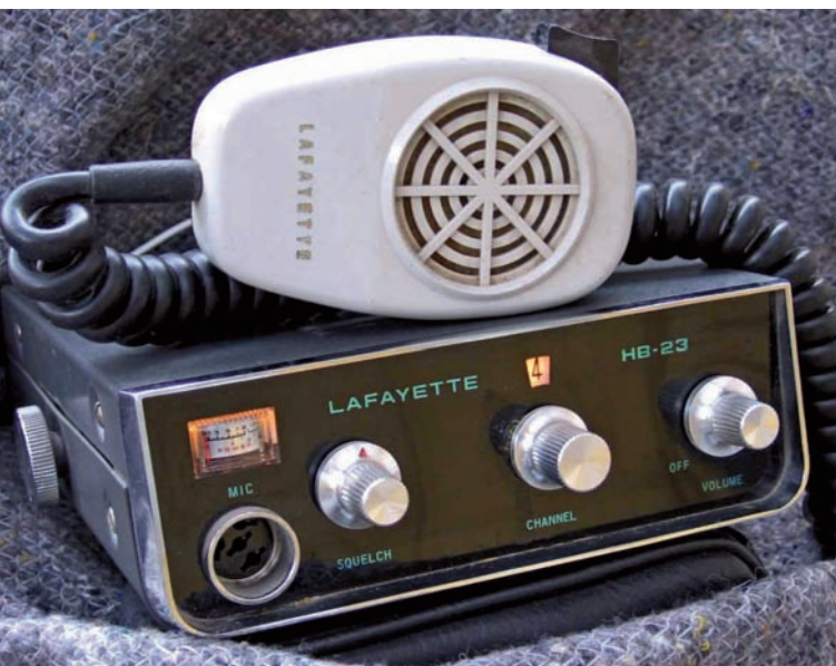
Figura 1 - Il Lafayette HB-23, un classico "baracchino" CB, appartiene all'era in cui si giudicava la sensibilità del ricevitore con la sola misura in microvolt per 10 dB (S+N)/N. Ma le liti tra vicini (in frequenza) per QRM d'imprecisata natura erano già frequenti.
