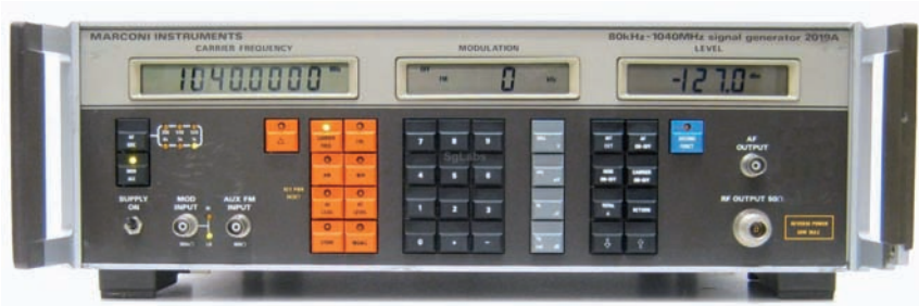
Figura 3 - Il generatore RF Marconi 2019A. Per misure di sensibilità dinamica ci vogliono due generatori, come questo o equivalenti
