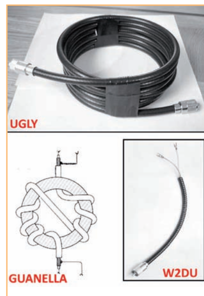
Figura 6 - Esempi di balun in corrente tipo "choke". I tre balun utilizzano tutti il medesimo principio
