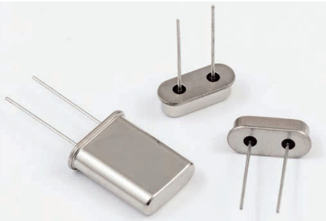
Figura 1 - Piccoli quarzi, in contenitori HC18/U e HC49/U, che offrono stabilità dell'ordine di 5-50 ppm a temperature normali
