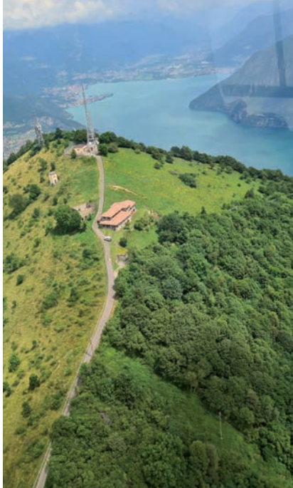
Figura 4 - Postazione vista dall'elicottero del nodo "master" della rete simulcast DMR. Da questa postazione, il master "vede" tutti gli altri ripetitori e li mantiene in sincrono tramite link in UHF.
