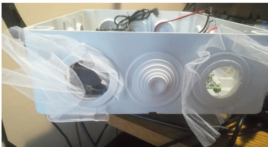
Fig. 2 - Tulle di protezione aperture (prima di essere rasato ai bordi...)
