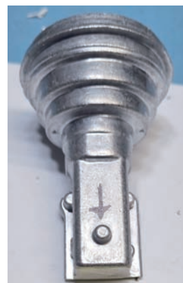
Foto 6 - Limare fino a scoprire il perno e toglierlo
