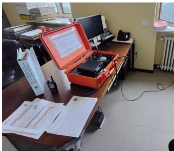
Figura 9 - Allestimento "standard" di un COC attraverso l'uso di una valigetta radio-regionale autoalimentata.
