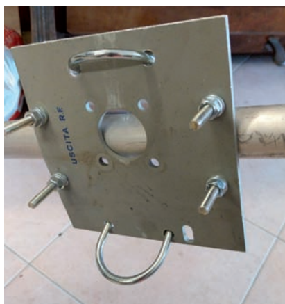
Piastra centrale alluminio 110x110x3 mm cavallotti (u bolts) interasse 40 mm diametro 6.
