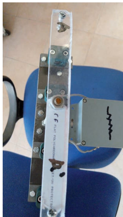
Barra di plexiglass 210x20x10, fori a 190 mm diam 5 mm. Foro centrale diam 10 mm
