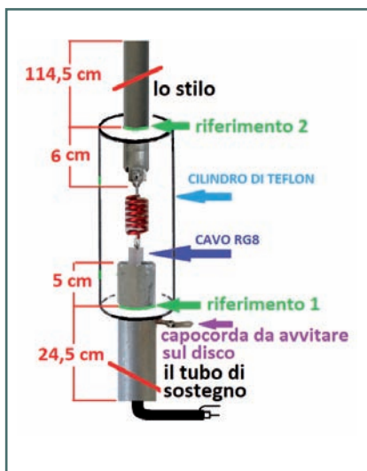
Fig. 8 - Piano di montaggio
