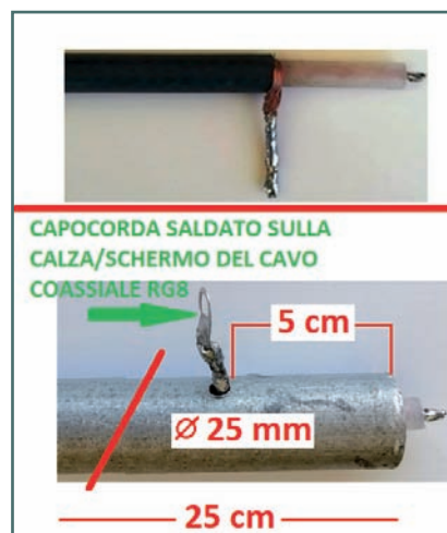
Fig. 7 - Dimensioni del tubo di sostegno
