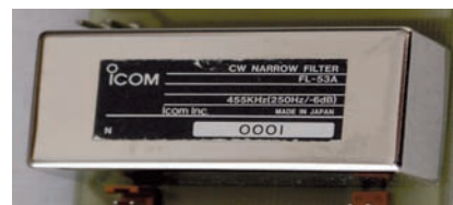
Figura 5 - Filtro a quarzo per CW stretto (250 Hz) di produzione Icom. Questa versione lavora a 455 kHz, ma la gran maggioranza dei filtri a quarzo lavora a frequenze più alte (5 - 20 MHz).
