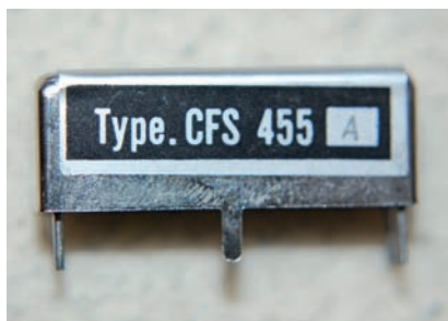
Figura 3 - Filtro ceramico a 455 kHz. Componenti di questo tipo danno una selettività discreta per l'AM, da scadente a discreta per l'SSB, inadeguata per il CW.
