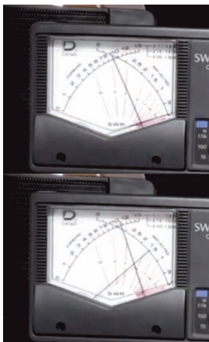
Figura 3 - Indicazioni del ROSmetro in presenza di carico adattato (sopra) e disadattato (sotto). Nel primo caso, la potenza diretta è di 90W mentre quella riflessa è zero. Nel secondo caso la potenza riflessa è di 15W, ma quella diretta è salita a 105W. Come è possibile? Nel testo tutti i dettagli
