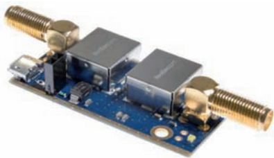
Foto 2 - Il preamplificatore con filtro SAW banda L
