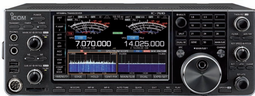
Figura 3 - L'Icom IC-7610 è un moderno apparato, di costo medio, del tipo SDR con DDC. Come si vede dall'immagine, esso dispone di due ricevitori
