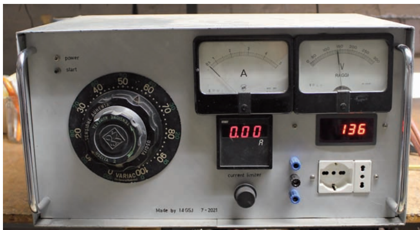
Foto del frontale con amperometri e voltmetri sia analogici che digitali e manopola di regolazione della corrente di soglia (tutta roba di recupero che avevo in casa).
