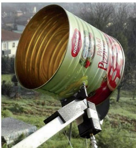
Foto 4 - Antenna a barattolo con monopolo
