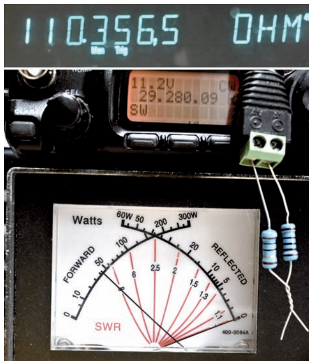
Figura 1 - Cavo a 75Ω lungo ¼ d'onda terminato da un resistore da 110Ω. Non essendo il carico adattato all'impedenza del cavo, sicuramente vi sono riflessioni, eppure il ROSmetro indica ROS 1.
