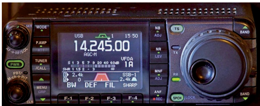
Figura 2 - L'IC-7000 è un RTX di circa vent'anni fa, ma ancora valido. Il piccolo Icom contiene un'intera stazione radioamatoriale: HF, 2 m e 70 cm
