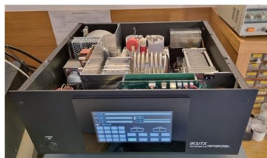
Foto 4 - Alcune fasi costruttive con la realizzazione del vano valvole e ventilazione, la disposizione dei componenti per la parte a RF e una prima vista d'insieme.
