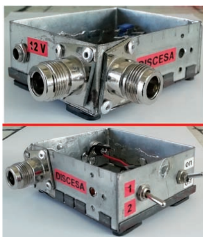
Fig. 10 - L'inseritore di tensione inscatolato
