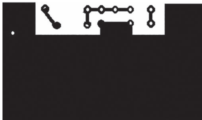
Fig. 12 - Circuito stampato dell'inseritore di tensione; versione 2 antenne - 2 RX
