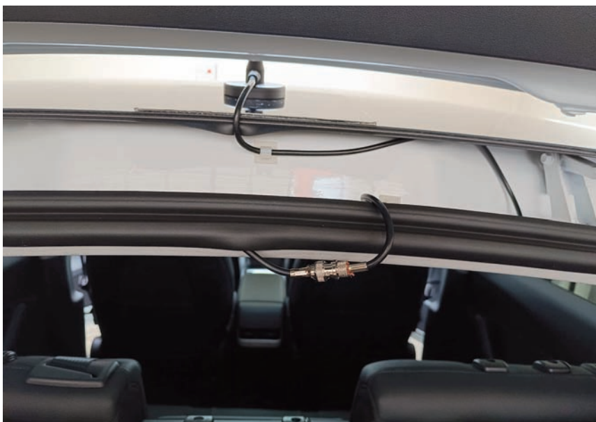
Passaggio del cavo antenna
