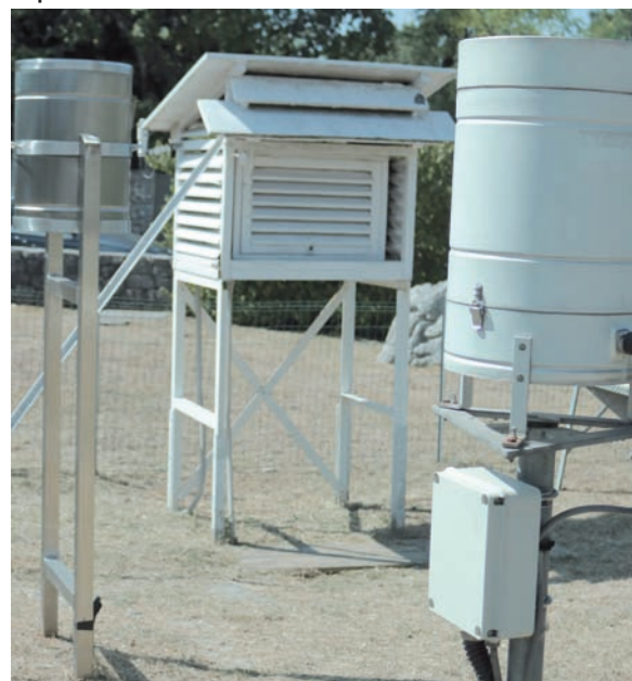
Foto 4 - Pluviometri in evidenza davanti a una capannina Stevenson
