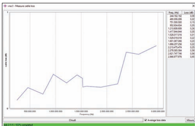
Fig. 4 - Misure di insertion loss della patch a 75 \Omega
