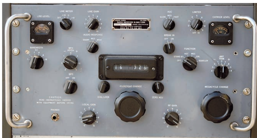
Figura 1 - L'R-390 che precedette l'R-390A. Il comando ANT TRIM è sotto lo strumento CARRIER LEVEL. Il comando FUNCTION ha una posizione in più: SQUELCH. La soglia dello squelch si regola con l'RF GAIN. Il comando AUDIO RESPONSE ha una posizione in più: MED (un passa basso a 3.500 Hz). La radio è descritta, brevemente, nella prima parte dell'articolo.
