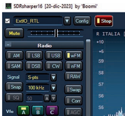
Fig. 12 - In SDRsharp, il ricevitore deve essere avviato con l'opzione ExtIO_RTL.dll
