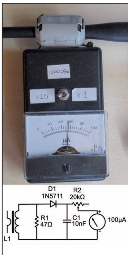
Fig. 22 - Amperometro RF a sonda toroidale. Uno strumento indispensabile di semplicissima realizzazione.
