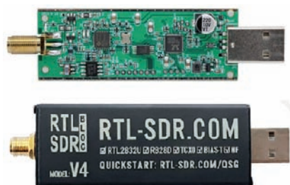
Fig. 1 - Il ricevitore RTL SDR V4
