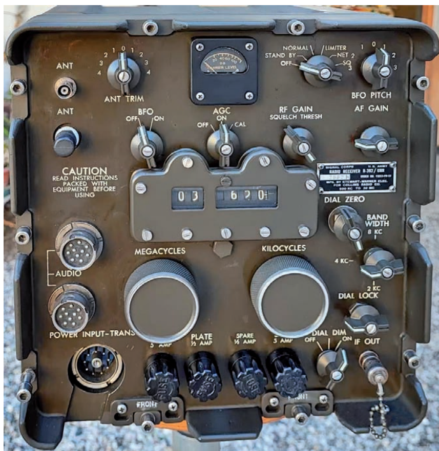
Figura 4 - L'R-392, la versione mobile dell'R390. L'aspetto è decisamente più spartano se confrontato con gli altri ricevitori della famiglia
