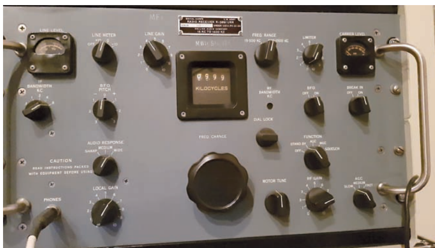
Figura 2 - Un bellissimo esemplare di R-389. Salta agli occhi l'assenza di una grossa manopola per i MHz, sostituita dal comando FREQ RANGE, in alto a destra rispetto alla scala.
