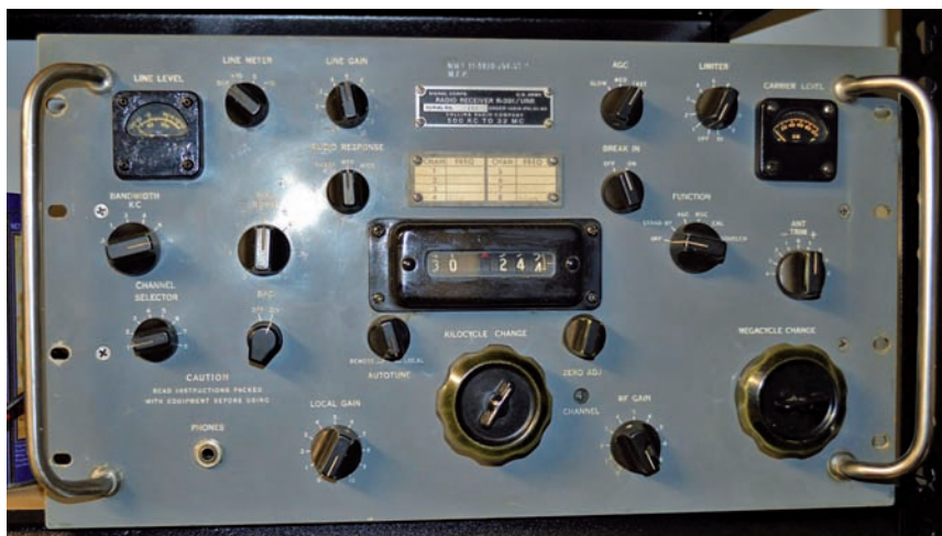
Figura 3 - L'R-391, coevo dell'R-390 da cui differisce solo per il comando CHANNEL SELECTOR sotto BANDWIDTH e per l'indicatore CHANNEL sotto ZERO ADJ.
