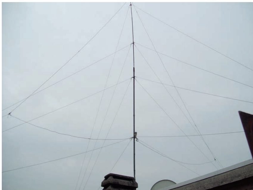
La foto 1 mostra a destra e sinistra i due bracci della delta loop: I puntini neri sono isolatori che terminano la parte orizzontale e iniziano i due lati verticali. Il bicchiere capovolto contiene il balun collegato al cavo e ai due bracci orizzontali.
