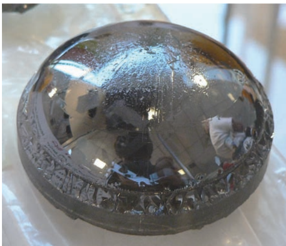
Monocristallo di carburo di silicio (Laboratori Minattec di Grenoble)
