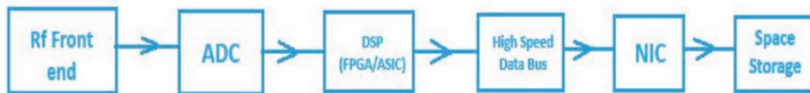
Sistema di trasferimento ad alta velocità e archiviazione su disco del flusso dati
