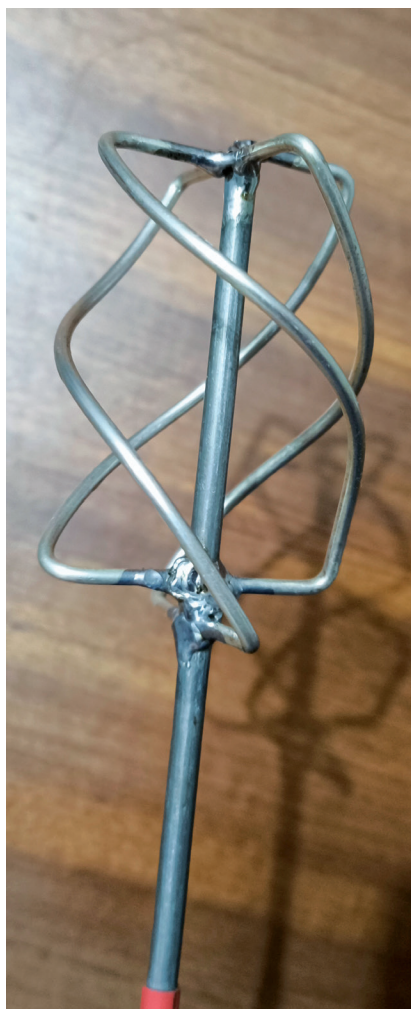
Fig. 3 - Prototipo realizzato con spezzone di coassiale semirigido
