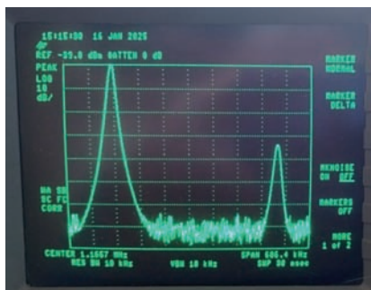
Fondamentale a 455 kHz e seconda armonica sotto di 34 dB circa
