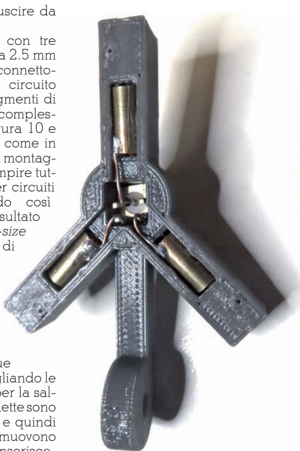
Fig. 11 - La struttura a "Y" con inseriti i tre morsetti connessi al connettore SMA da circuito stampato che esce sul retro
