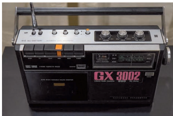
Radioregistratore che usai nel 1977 appena tredicenne per ascoltare la SSB/CW col BFO a 455 kHz esterno.
