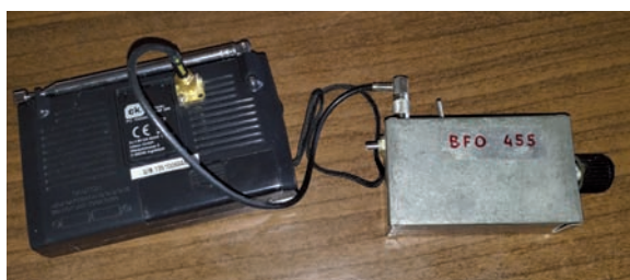
Connessione tra BFO e ORF200 (ho usato un connettorino femmina SMA sulla radiolina)
