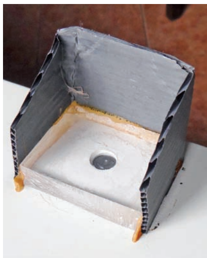
Fig. 2 - Telecamera con protezione in plexiglass e tegolino in plastica parapioggia
