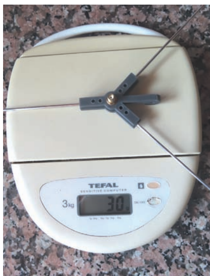
Fig. 13 - Sulla bilancia, l'intera antenna pesa appena 30 g!
