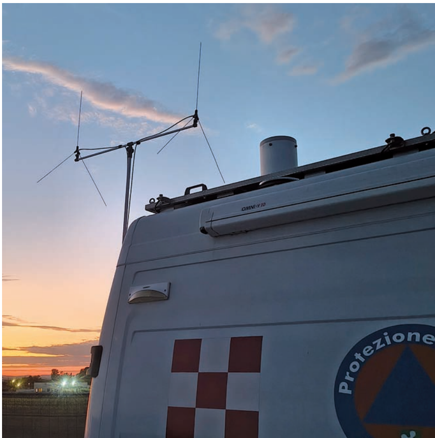
Fig. 14 - Due GP VHF da 30g montate sul retro del Centro Trasmissioni Mobile Regionale n.1 a Tor Vergata (Roma) durante il servizio per il Giubileo dei Giovani del 2025 e utilizzate dal sistema di geolocalizzazione delle radio DMR
