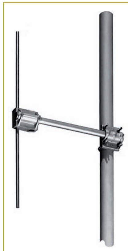
Fig. 4 - Un dipolo a polarizzazione verticale deve essere installato con un braccio che si allontani orizzontalmente di almeno mezz'onda dal palo. Questo rende l'uso del dipolo verticale meno pratico di altre soluzioni che si installano direttamente in testa al palo
