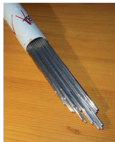
Fig. 7 - Barre per saldatura TIG in alluminio da 2.4 mm di diametro e 1 m di lunghezza
