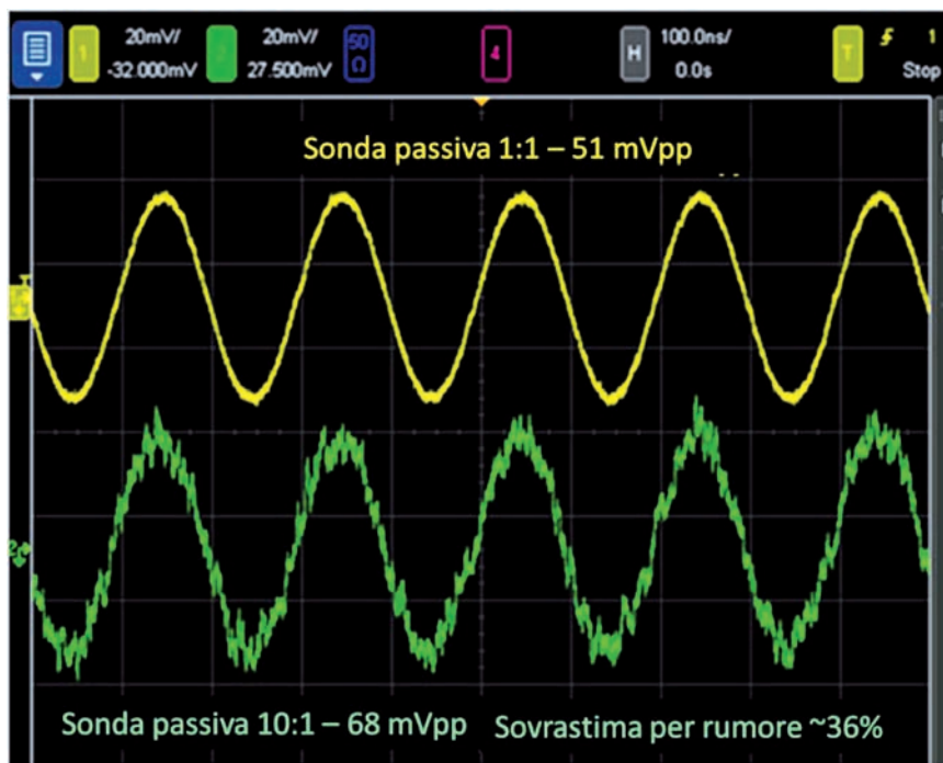
Fig. 13 - Un'onda sinusoidale da 50 mVp-p misurata con sonde 1x e 10x.
