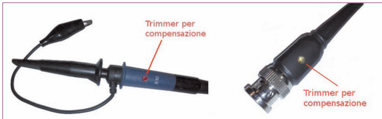
Fig. 8 - Trimmer di compensazione in una sonda passiva 10x
