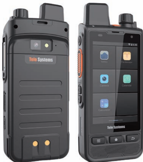
Fig. 4 - Apparati PoC più evoluti, dotati di ampio display e fotocamera. Nonostante il display, conservano un'interfaccia semplice e con poche funzioni
