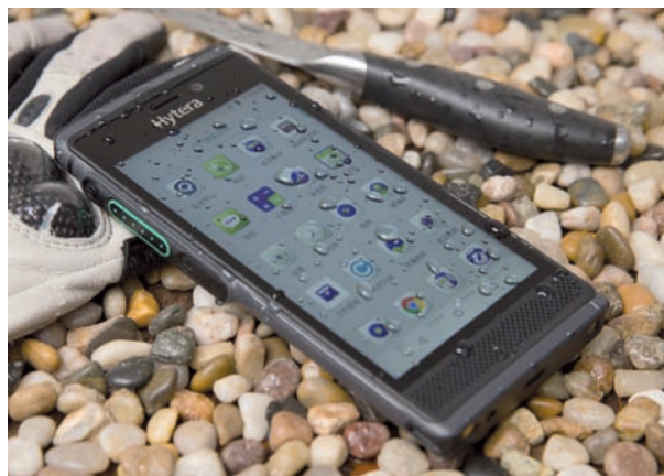
Fig. 6 - Smartphone "rugged" con PTT fisico e altoparlante frontale di grandi dimensioni. Incorpora le funzioni di uno smartphone e di una radio PoC in un unico apparato.
