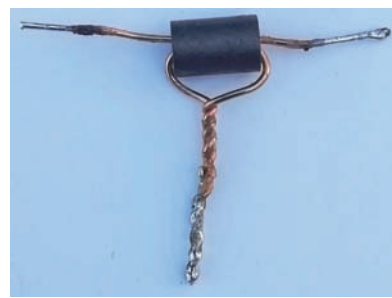
Fig. 5 - L1A - L1 B realizzata con un solo nucleo
