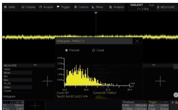
Fig. 1 – Rumore residuo del DSO con sensibilità impostata a 500 \mu V/div , ingresso CH1 e carico di 50 \Omega .
