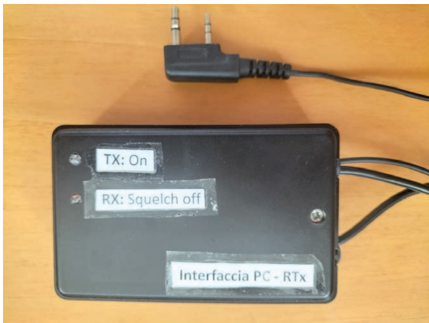
Fig. 5 - Realizzazione finale con cavetto audio in/out preintestato Baofeng UV-5R.
