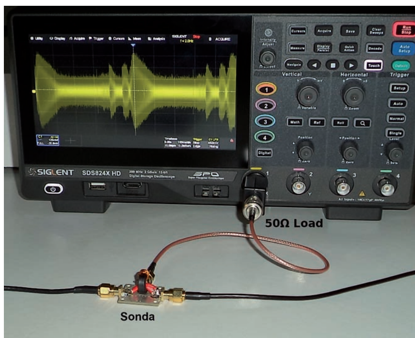
Fig. 5 - Set-up di misura che impiega la sonda di corrente
