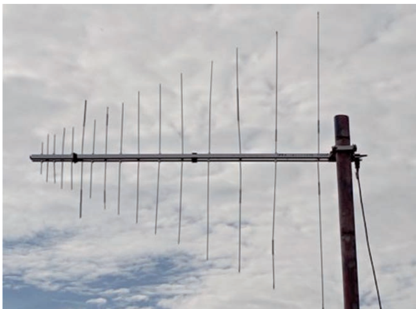
Antenna LPDA per 2m e 70cm finita e tarata
