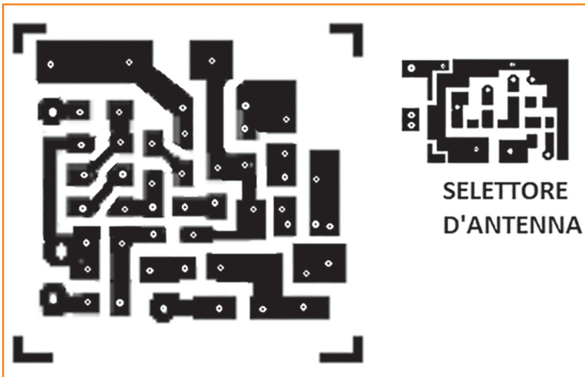
Fig. 4 - Circuiti stampati dell'attenuatore (6 x 5,5 cm) e del deviatore (3,2 x 2 cm)
