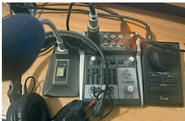
La mia stazione remota composta da microfono Icom SM-6, mixer per la parte audio in/out e l'encoder RC-28.
