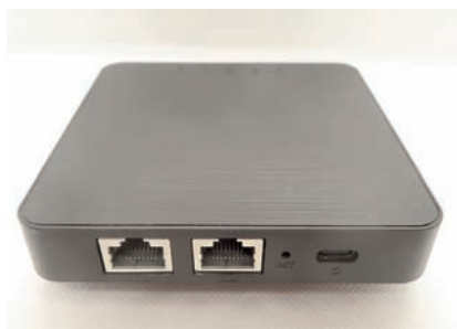
Fig. 3 - Router LTE/4G Wobicom CPE301K; accetta una SIM di qualunque gestore e fornisce la connettività Internet tramite WiFi o due porte ethernet
