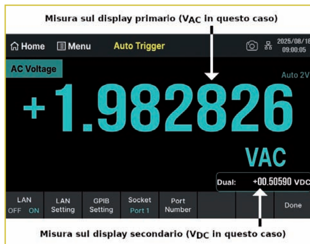
Fig. 3 - Le due misure contemporanee che il display ci restituisce in una misura combinata, qui la grandezza elettrica è una tensione ma lo stesso meccanismo vale anche per le correnti.
