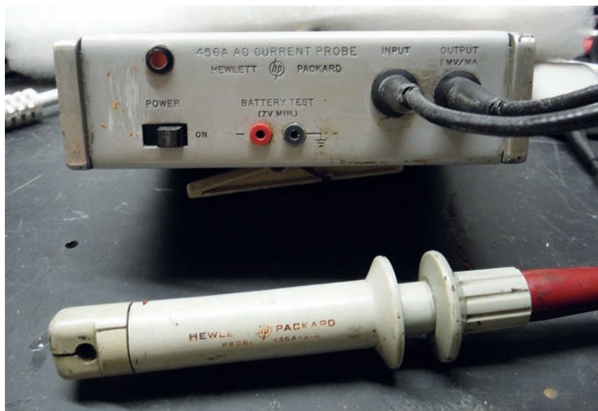
Fig. 2 - Vista della mia HP 456A, sonda e amplificatore
