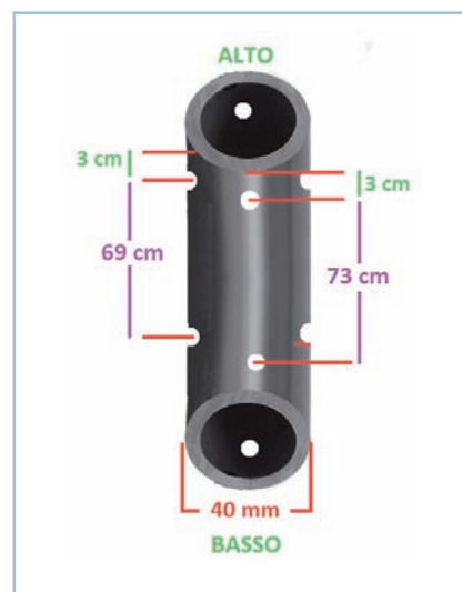
Fig. 3 - Foratura del tubo portante in PVC
