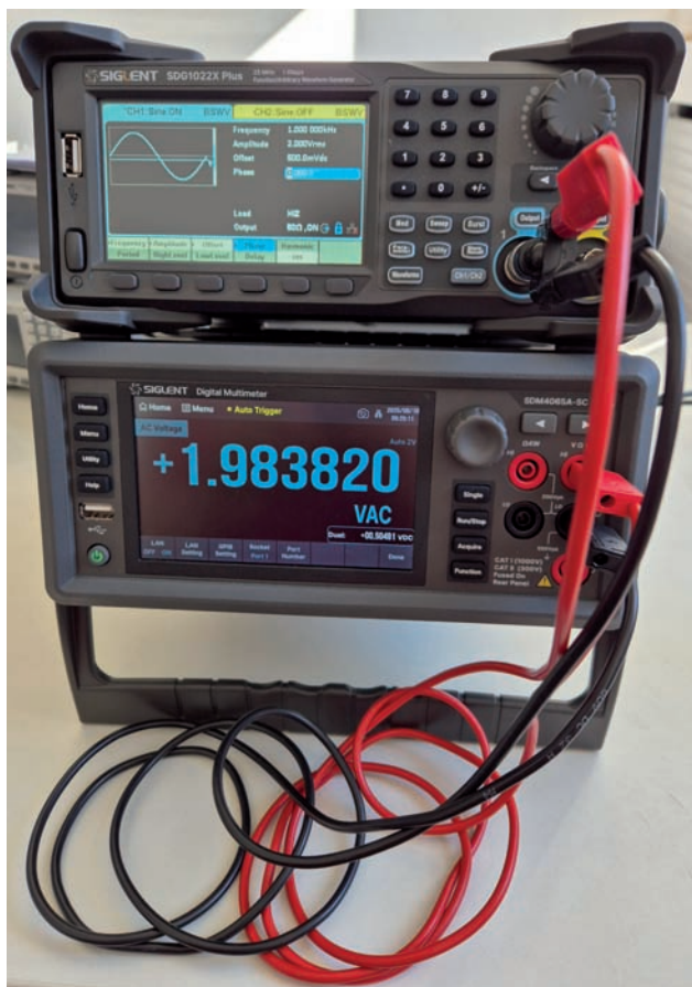
Fig. 2 - Il display del multimetro può mostrare due misure contemporanee. Qui per esempio in primo piano abbiamo la tensione alternata e in secondo piano la tensione continua riferite al medesimo segnale fornito come test
