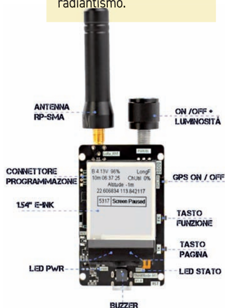
Interno del tinknode M1 lato fronte
