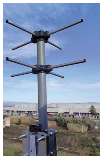
Foto 5 - Turnstile UHF tubi tondi 10mm e in versione Flat bt IZ5RZR
