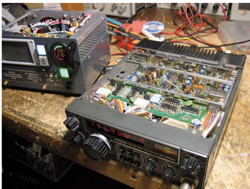
IC 260E in fase di riparazione.
