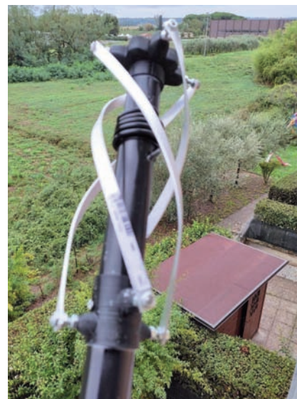
Foto 6 - Antenne QFH UHF in polarizzazione RHCP by. IZ5RZR
