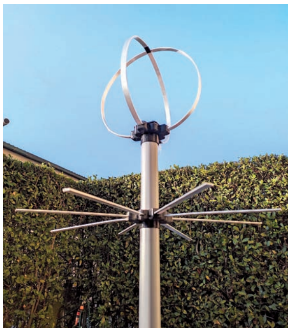
Foto 7 - Antenna EGGBEATER UHF polarizzazione RHCP by IZ5RZR
