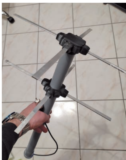
Foto 5 - Turnstile UHF tubi tondi 10mm e in versione Flat bt IZ5RZR
