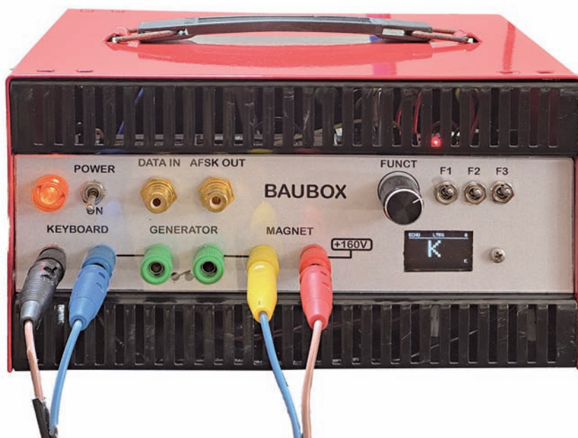
Il "Baubox" descritto nell'articolo, ricavato dal contenitore di un vecchio caricabatterie. Il nome richiama il codice Baudot, utilizzato dalle telescriventi a 5 bit
