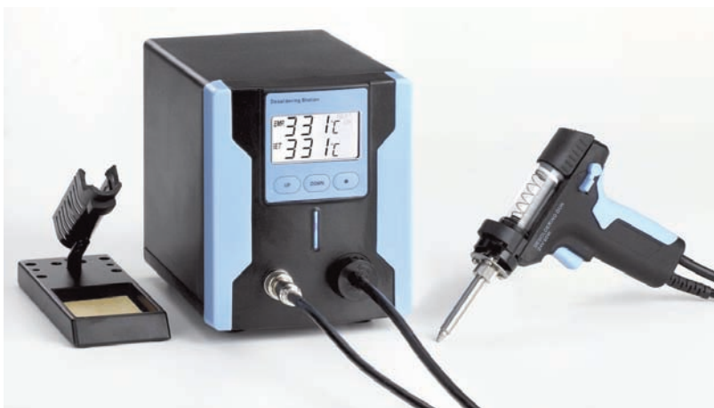
Fig. 6 - Stazione dissaldante ad aspirazione; in pratica è un saldatore con una punta forata coassialmente dalla quale viene aspirato lo stagno
