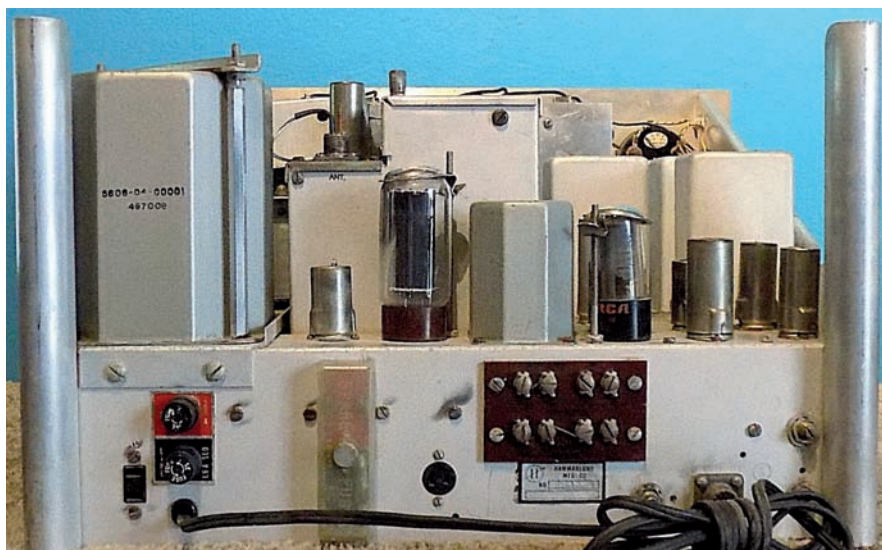
Fig. 1 - Un SP-600-JX-21A visto da dietro. Sulla sinistra si nota il trasformatore di alimentazione in un contenitore ottagonale. Quasi al centro, a destra della finale audio 6V6GT, c'è il trasformatore d'uscita, anch'esso ottagonale.
