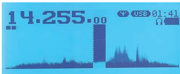
Fig. 2 – L'analisi di spettro mostra uno span di 40 kHz, più ampio entro la banda FM di radiodiffusione
