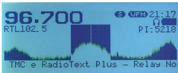
Fig. 3 - La decodifica RDS mostra il nome dell'emittente, il testo dinamico e il codice PI.
