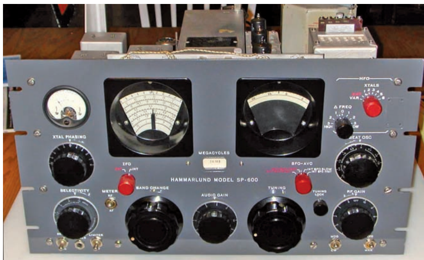
Fig. 5 - Frontale di un SP-600-JX-17. Si notino le piccole manopole rosse. Il ricevitore è previsto per lavorare in diversity.
