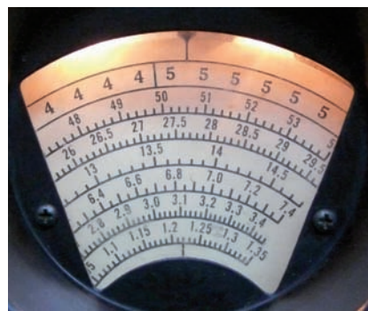
Fig. 4 - Scala della sintonia di un SP-600-JX. Gli 80 m hanno una divisione ogni 20 kHz, i 40 m una ogni 50 kHz... I 10 m hanno una divisione ogni 100 kHz e i 6 m una ogni 200 kHz. La scala indica 1,22 MHz.
