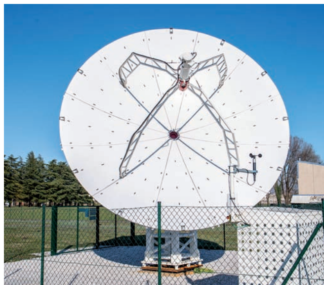
Foto 5 - La 5 metri puntata sul Sole, utilizzandone l'ombra per la perfetta centratura
