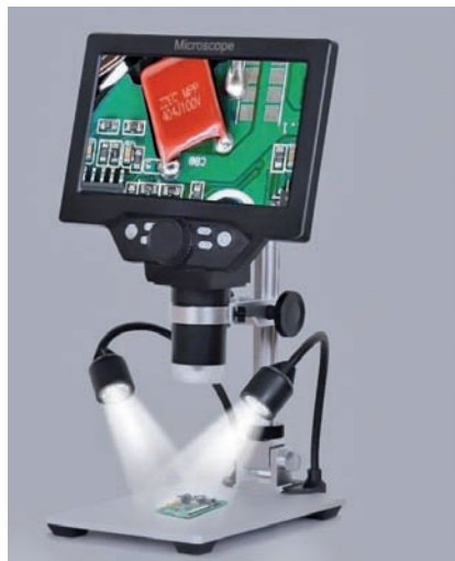
Fig. 3 - Il microscopio per elettronica è assolutamente indispensabile. I modelli con telecamera e display sono economici e perfettamente adatti a lavorare sui PCB.
