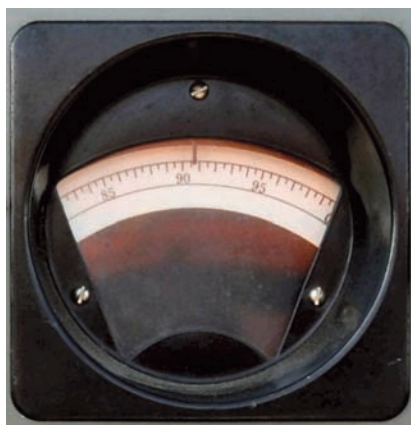
Fig. 3 - La scala band spread del ricevitore. Le parti in cui è divisa la scala da 0 a 100 sono 200, una ogni mezza divisione
