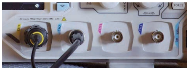
Fig. 2 - Dettaglio con la scritta che avvisa del pericolo ("All inputs 1 MΩ // 300 V RMS CAT 1").
