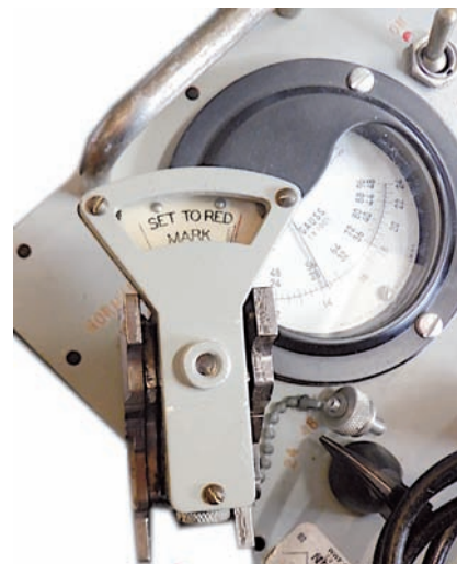
Fig. 6 - Misura di un flusso di 2800 G. Notare l'allineamento dell'indice del probe alla tacca rossa
