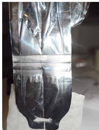
Foto 13 - Le impronte dello heat sealer sul collo del pallone
