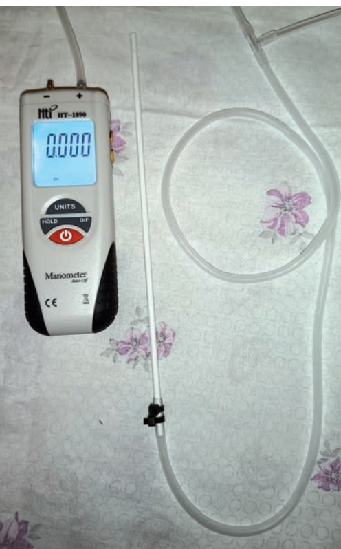
Foto 9 - Manometro e sonda per il test di pressione
