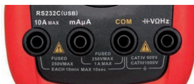
Fig. 4 - Le scritte, aidate da due triangolini gialli, indicano i principali valori di tensione e corrente da non superare nell'UT61E
